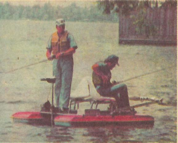
**РЫБАК РЫБАКА УВИДИТ ИЗДАЛЕКА,** восседая на этом оригинальном снастии. Это и катамаран и плот одновременно. Два пластмассовых pontона собираются в единую конструкцию, кстати, довольно устойчивую, на которую можно поставить стулья и навесить мотор в 10 л. с. Вес ее — 40 кг. В каждом pontоне предусмотрены отделения для хранения рыболовных приспособлений, снастей, продуктов и... рыб.
