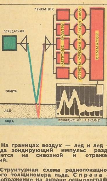
На границах воздух — лед и лед — вода зондирующий импульс разделяется на сквозной и отраженный.
