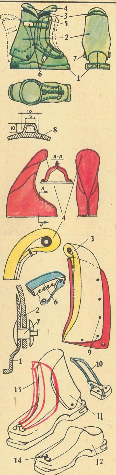
того резинового коврика. Его изнутри прокладываем синтетической тканью «эластик», а снаружи — «болонью». Стельку по размерам подошвы вырезаем из кожи или кожзама и пришиваем наружным швом. Верхнюю часть внутреннего ботинка со стороны язычка подкрепляем искусственной кожей на высоту  $10-15$  см. А внутрь внешнего жесткого ботинка вкладываем стельку из пенопласта толщиной в заднике  $25-30$  мм и в носке  $10-12$  мм. Толщиной стельки можно регулировать положение ступни в ботинке.
