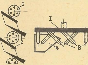
Его рабочие органы — диски 1 с вертикальной осью вращения, усаженные заостренными пальцами 3, и отвальные корпуса 2 (схему их расположения см. на рис.). Диски смонтированы так, что их ось находится над открытой частью борозды и смещена относительно обреза лемеха 4 в сторону отваливаемого пласта. Сами пласти подрезаются с глубины 20—25 см, а затем разбиваются и крошатся пальцами при поворотах диска, который вращается за счет разной плотности почвы.
