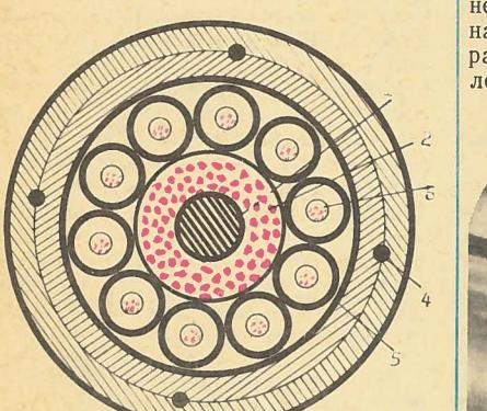
двойной оболочкой из пластика и полиэтилена. Между слоями этой оболочки пропущены упрочняющие элементы 4 из высокопрочных полимерных нитей. Несмотря на такую «конструктивную насыщенность», диаметр кабеля всего 6 мм.
