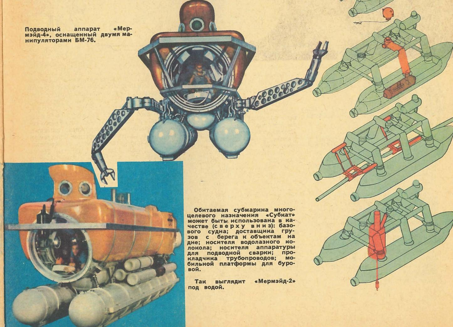
Обитаемая субмарина многоцелевого назначения «Субкат» может быть использована в качестве (сверху вниз): базового судна; доставщика грузов с берега к объектам на дне; носителя водолазного колокола; носителя аппаратуры для подводной сварки; прокладчика трубопроводов; мобильной платформы для буровой.
