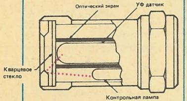
Задача оказалась по плечу специалистам компании «Дата троникс». В корпусе датчика монтируется ультрафиолетовая лампа. Контрольное устройство, автоматически включая ее, проверяет, пропускает ли объект датчика «ультрафиолет» или нет. Если нет, то на пульте зажигается соответствующее табло (США).
