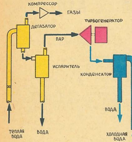
Плавучая термальная электростанция фирмы «Локхид». Труба для забора холодной воды уходит на километр вглубь.
