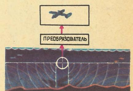
нием специальных аналого-цифровых преобразователей. Информация от сонара поступает в ЭВМ, и та строит «выправленную» панораму, используя данные о скорости аппарата и его расстояния от дна. Кроме того, ЭВМ может увеличивать контрастность получаемого изображения, выдавать в увеличенном виде часть панорамы вместо полной картины и т. д. Изображение может выдаваться также не на бумаж-
