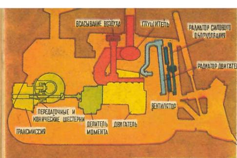
Супертрактор «Катерпиллер Д-10» мощностью 700 л. с. сконструирован для тяжелых и крупномасштабных землеройных работ, которые не под силу иным машинам этого класса. Его ширина составляет 6,10 м; длина (с отвалом и рыхлителем) — 9,48 м; высота до верха выхлопной трубы — 4,57 м. Эксплуатационный вес — 83 т.
