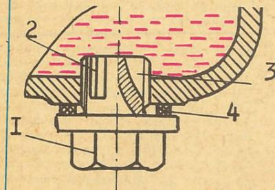
ности прорезаны канавки постоянного 2 или переменного 3 проходного сечения. Пробка винчивается в отверстие дна корпуса с герметизирующей прокладкой 4. Скорость слива жидкости регулируется изменением величины проходного сечения при отворачивании пробки.
