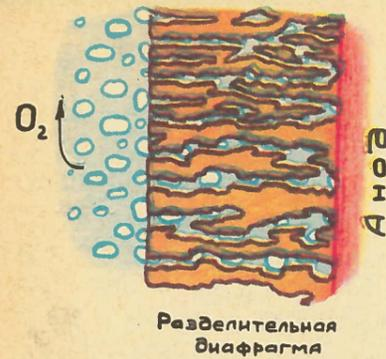
Многочисленные поры пронизывают диафрагму, чтобы дать возможность кислороду, образующемуся в процессе электролиза воды на аноде, выйти на поверхность.
