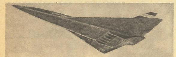
Сразу же после взлета турбореактивные разгонят самолет до скорости около 965 км/ч, после чего включатся прямоточные двигатели и скорость возрастет до 3200 км/ч. Полет на высоте 35 тыс. м исключит звуковой удар. Когда турбореактивная система выключится, прямоточная разгонит самолет до крейсерской скорости — 6400 км/ч. Самолет сможет пролететь 8722 км, разделяющие Лос-Анджелес и Токио, за 2 ч 18 мин, включая взлет и посадку на дозвуковой скорости (США).
