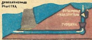
Высота волн на протяжении 400 м составит от 15 до 30 м. Через специальный канал они поднимаются до резервуара-накопителя, расположенного в ста метрах над уровнем моря, а дальше попадут на турбины гидростанции. Специалисты подсчитали, что подобная система, протянувшаяся вдоль десяти километров Норвежского побережья, даст в год от 800 до 2000 гигаватт электроэнергии. Много это или мало? Для сравнения скажем, что Осло с населением в 472 тыс. человек расходует ежегодно 2900 гигаватт (Норвегия).
