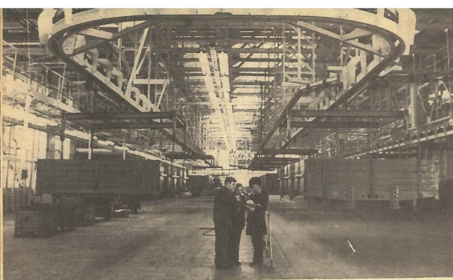
С введением в эксплуатацию участка сборки платформ закончился полный технологический цикл монтажа автомобилей ЗИЛ-133. На снимке: отделение сдачи. Весь участок по своим размерам равен большому цеху. Он расположен на втором этаже сборочного корпуса автозавода имени Лихачева. Занимаемая им площадь 19,5 тыс. кв. м. Общая длина конвейеров с подъемными механизмами для транспортировки деталей — 10 км.
