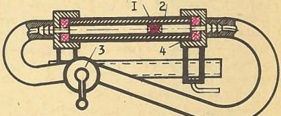
одного конца трубы (2) к другому под напором воздуха давлением в 5—6 атм, сокрашая все наслоения и до блеска начищая металл. Направление потока воздуха меняется поворотом рукоятки крана (3), соединенного шлангами с воздушной сетью и стойками. Резиновые прокладки (4) уплотняют места соединений и амортизируют удары шомполя.
