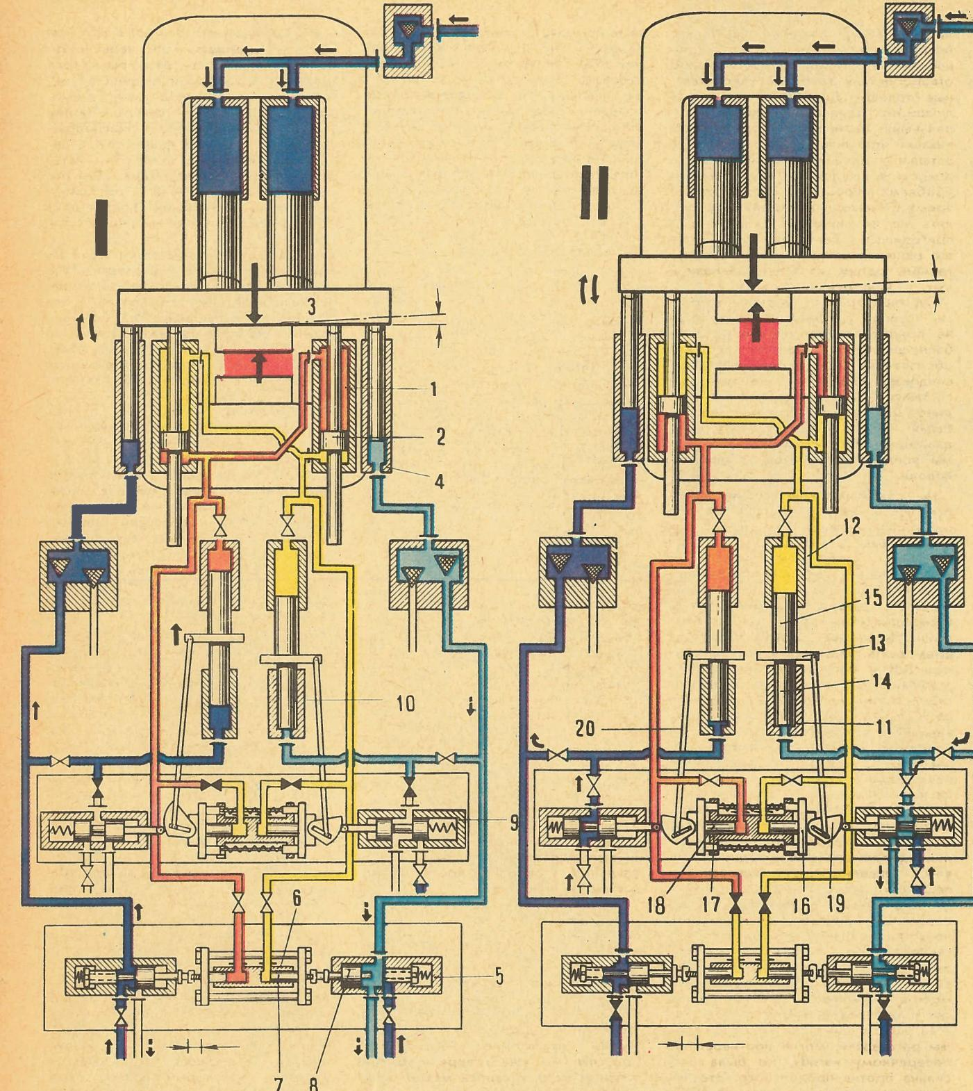
Схема системы синхронизации пресса усилием 65 тыс. тс (описание ее действия см. в тексте статьи).
