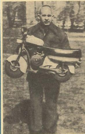
проделал на своем детище более 40 тыс. км по дорогам Польши, Италии и Франции. Заслугам «мини-гиганта» мог бы позавидовать любой «взрослый» мотоцикл. Конструкция малютки точно повторяет все узлы и агрегаты больших машин: трубчатая рама, подвеска на обоих колесах, трехступенчатая коробка передач, система освещения. Двигатель одноцилиндровый 2,5 л. с., максимальная скорость 60 км/ч (Польша).
