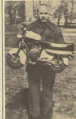
проделал на своем детище более 40 тыс. км по дорогам Польши, Италии и Франции. Заслугам «минигиганта» могли бы позавидовать любой «взрослый» мотоцикл. Конструкция маляти точно повторяет все узлы и агрегаты больших машин: трубчатая рама, подвеска на обоих колесах, трехступенчатая коробка передач, система освещения. Двигатель одноцилиндровый 2,5 л. с., максимальная скорость 60 км/ч (Польша).
