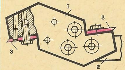
соединяются к плате с двух сторон штифтами и винтами. При затуплении одной грани пластину поворачивают, и в работу вступает другая.
