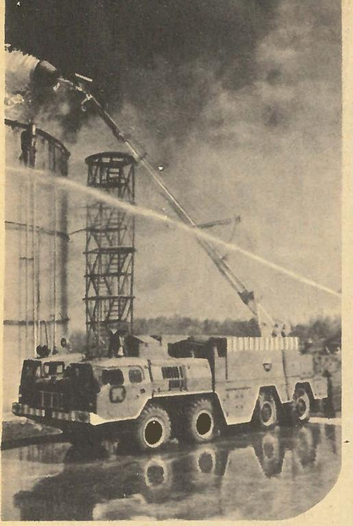
ления установлены в кабине и в задней части машины. На случай особо опасной ситуации предусмотрено дистанционное управление на расстоянии 50 м от машины. Для наблюдения за зоной пожара есть телевизионная камера; а для связи с управлением пожарной охраны — радиостанция.
