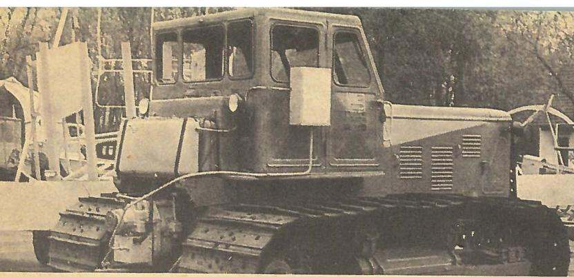
Но двигатель не глохнет, он набирает обороты. Когда они достигнут величины, при которой электронный блок перестает выдавать сигнал, тогда электрогидрозолотник срабатывает, закрывая сливное отверстие — дроссель запирается. Насос затормаживает солнечную шестерню. Крутящий момент передается на ведущие колеса. Машинно-тракторный агрегат продолжает движение уже с максимальной скоростью.
