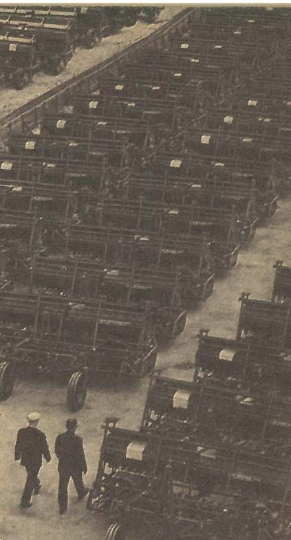
Готовы к весеннеей страде зернотуковье прессовые сеялки СЭП-3,6, отмеченные государственным Знаком качества. Выходят в поле машины на четырех пневмоколесах, а в местах, поврежденных ветровой эрозией, их преобразуют в прессовые, заменяя приводные колеса четырьмя секциями катков. Сеялки одновременно с высевом зерновых или зернобобовых семян вносят в почву гранулированные удобрения и прикатывают почву в засеянных рядах.
