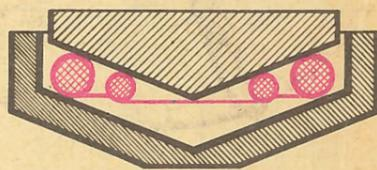
тальных колебаний резиновые кольца опоры имеют разные диаметры, а металлические конусные кольца установлены с радиальным зазором друг относительно друга.
