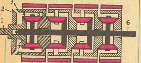
мере рассмотрения одного из четырех ее блоков (см. схему). При передвижении шестерни 2 вправо (прямая передача) крутящий момент от ведущего вала 1 к ведомому 6 передаст водило 3 через сателлиты 4 и ось 5. В этом случае сателлиты вращаются только вокруг горизонтальной оси.
