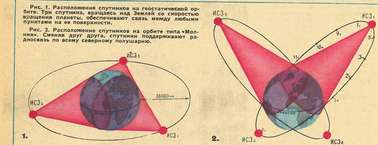
Рис. 1. Расположение спутников на геостатической орбите. Три спутника, вращаясь над Землей со скоростью вращения планеты, обеспечивают связь между любыми пунктами на ее поверхности.
