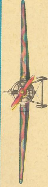
38. БОК-5 (СССР, 1937). Двигатель — М-11, 110 л. с. Размах — 9,86 м. Длина — 4,36 м. Площадь крыла — 23,15 м<sup>2</sup>. Вес пустого — 596 кг. Полетный вес 764 кг. Скорость максимальная — 174 км/ч. Потолок практический — 4850 м.
