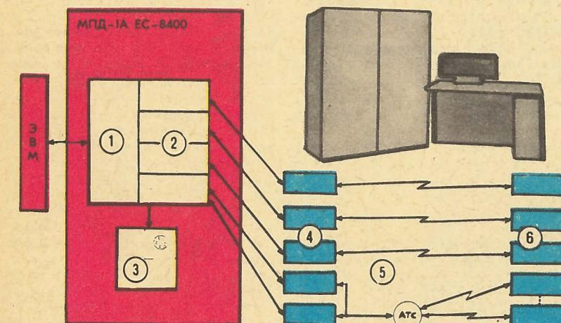
Рис. 3. Мультиплексор передачи данных ЕС-8400 (МПД-1А) контролирует потоки информации, идущие в ЭВМ.
