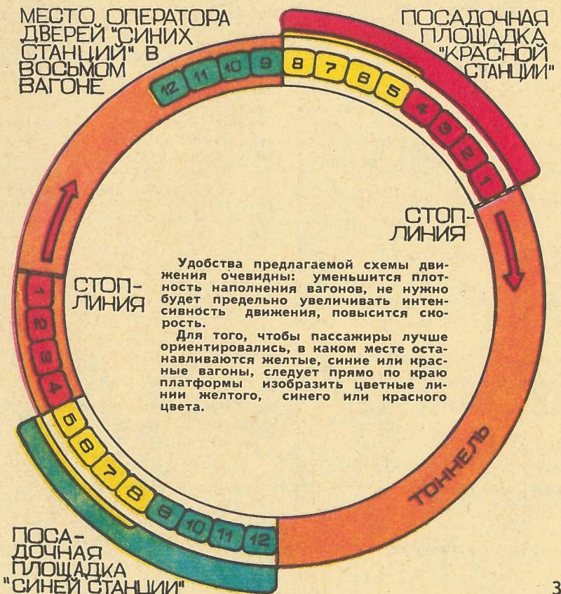
Удобства предлагаемой схемы движения очевидны: уменьшится плотность наполнения вагонов, не нужно будет предельно увеличивать интенсивность движения, повысится скорость.
