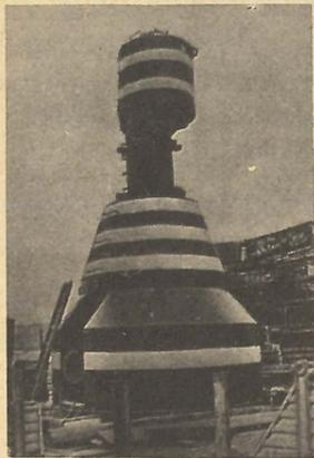
Но это еще не все. Особенности Геонура, отличающая его от всех прочих подводных аппаратов, состоит в том, что он может выполнять буровые изыскательские работы. Бур Геонура может углубляться в морское дно на 50—100 м. Добываемые при этом пробы полностью сохраняют свою структуру.
