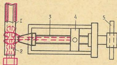
волоки, концы которой прикрепляют к подвижной гайке (4). Воротком (5) вращают винт (3), и тогда гайка передвигается и затягивает петлю. Концы проволоки скручиваются в тугий узел поворотом оправки. Такое соединение выдерживает давление до 20 атм.
