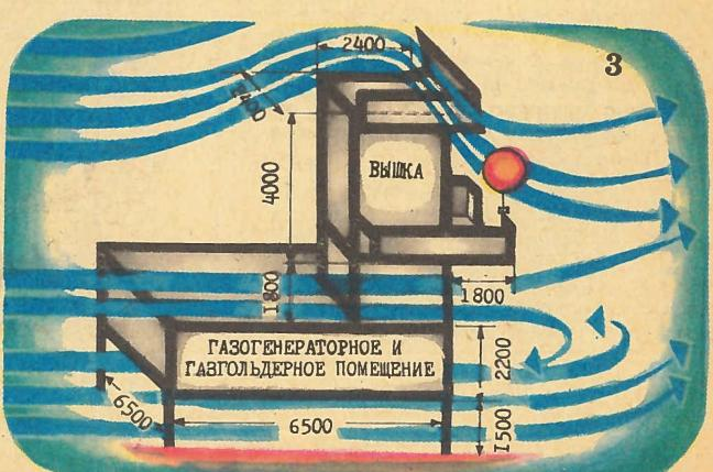
«Павильон на куриных ножках» уже более 10 лет успешно эксплуатируется на станции «Молодежная» (см. фото). К сожалению, аэробологи иногда засоряют просвет под сооружением баллонами, резиновыми оболочками и прочими отходами при запуске радиозондов. На мусоре скапливаются шлейфы снега, и постепенно высота просвета уменьшается, что приводит ко многим не приятностям.
