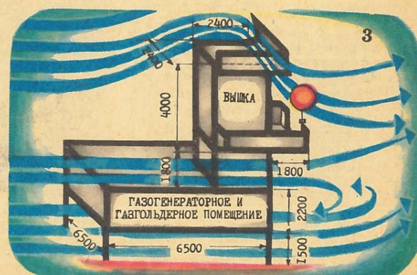
«Павильон на курьих ножках» уже более 10 лет успешно эксплуатируется на станции «Молодежная» (см. фото). К сожалению, аэрологи иногда засоряют просвет под сооружением баллонами, резиновыми оболочками и прочими отходами при запуске радиозондов. На мусоре скапливаются шлейфы снега, и постепенно высота просвета уменьшается, что приводит ко многим неприятностям.
