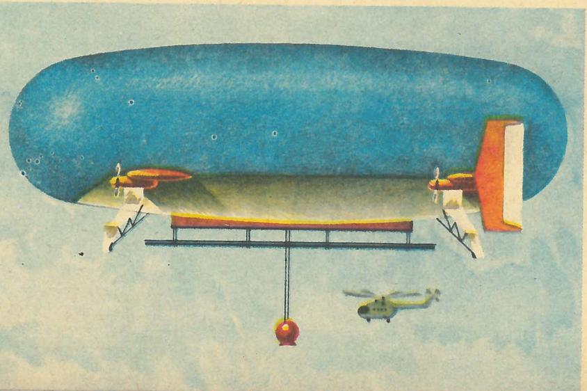
Исключительный интерес вызвал доклад кандидата технических наук М. Локшина (Москва) о применении дирижаблей и привязанных аэростатов для телевизионного вещания и связи в Тюменской области. Такой аэростат, висящий на высоте 3—4 км, может быть оснащен телевизионными ретрансляторами или их антеннами. Выгода значительна: большая зона обслуживания при неболь-
