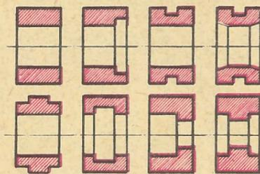
этой технологии перед кузнечной не только в скорости и экономичности (за счет уменьшения на 25% расходования металла и сокращения трудоемкости кузнечных и механических работ на 30—35%). Таким способом можно получить кольца фасонного профиля (см. рис.) и избежать двойного нагрева металла.
