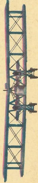
Вверху — «Хендли-Пейдж 0/400» (Англия, 1917). Экипаж — 3 чел. Двигатели — 2× «Роллс-Ройс Игл VII» по 275 л. с. Взлетный вес — 6375 кг. Размах — 30,50 м. Длина — 18,90 м. Площадь крыльев — 153 м<sup>2</sup>. Полная нагрузка — 2525 кг. Максимальная скорость — 155 км/ч. Вооружение — 2 спаренных пулемета, 820 кг бомб.
