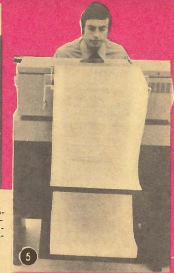
Некоторые элементы системы подготовки рукописи: 3 — процессор ЭВМ, 4 — банк данных, 5 — быстропечатающее устройство, 8 — дисплей, 10 — фотонаборный автомат.
