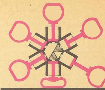
**Гибрид колеса и шагающего механизма** предложен изобретателями МВТУ. Движитель — радиально закрепленные вокруг оси цилиндры с поршнями, на полых штоках которых помешены эластичные камеры. При подаче сжатого воздуха в цилиндр шток выдвигается, камера надувается и отталкивается от грунта, поворачивая колесо. С падением давления воздуха в цилиндре и камере поршень убирается обратно.
