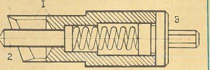
при помощи заостренного стержня 2, проходящего через центр инструмента. Вращение передается через хвостовик 3, который во время работы подсоединяют к пневматическому пистолету.
