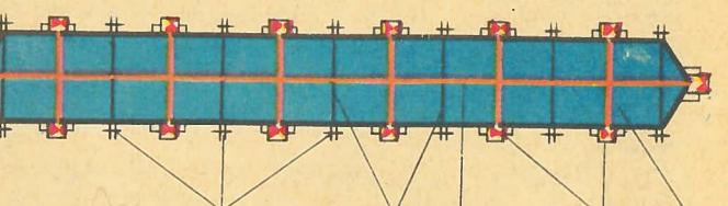
Устройство сверхмощной бомбы для самолета-снаряда ТБ-3. Бомба собирается внутри фюзеляжа из шести цилиндрических отсеков.
