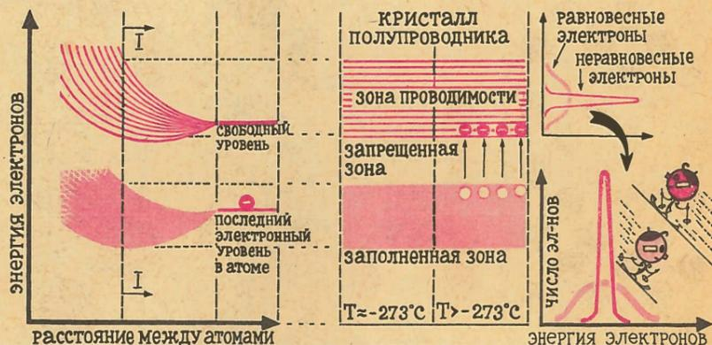
ды, скажем, от батарейки карманного фонарика, как электроны, гонимые электрическим полем, дружной толпой устремятся в одном направлении, образуя электрический ток. В полупроводниковых кристаллах нет свободных электронов. Они образуются благодаря тепловым колебаниям атомов или в результате воздействия на вещество света. При этом некоторые «связанные» электроны, принадлежащие атомам или ионам кристаллической решетки, отрываются от своих владельцев и переходят в разряд свободных.
