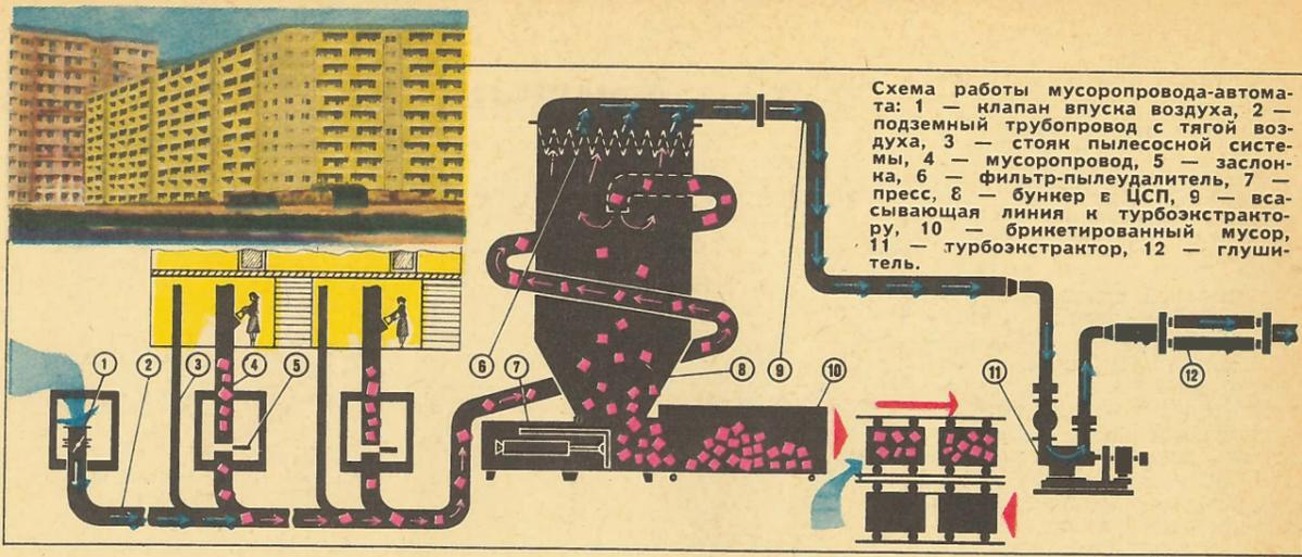
Схема работы мусоропровода-автомата: 1 — клапан выпуска воздуха, 2 — подземный трубопровод с тягой воздуха, 3 — стояк пылесосной системы, 4 — мусоропровод, 5 — заслонка, 6 — фильтр-пылеудалитель, 7 — пресс, 8 — бункер в ЦСП, 9 — всасывающая линия к турбозкрантору, 10 — брикетированный мусор, 11 — турбозкрантор, 12 — глушитель.
