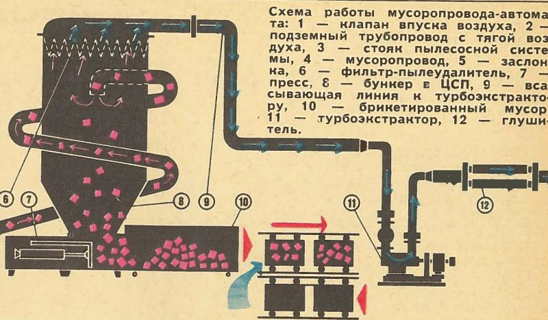
Схема работы мусоропровода-автомата: 1 — клапан впуска воздуха, 2 — подземный трубопровод с тягой воздуха, 3 — стояк пылесосной системы, 4 — мусоропровод, 5 — заслонка, 6 — фильтр-пылеудалитель, 7 — пресс, 8 — бункер в ЦСП, 9 — всасывающая линия к турбоэкстрактору, 10 — брикетированный мусор, 11 — турбоэкстрактор, 12 — глушитель.
