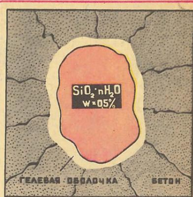
Частица кремния (в бетоне) с аморфным кремнеземом ( $\text{SiO}_2 \cdot n\text{H}_2\text{O}$ ). Имеет водопоглощение  $W$  в 0,5%. Цемент содержит щелочи 1,6%. Образуется гелевая оболочка, и бетон растрескивается.
