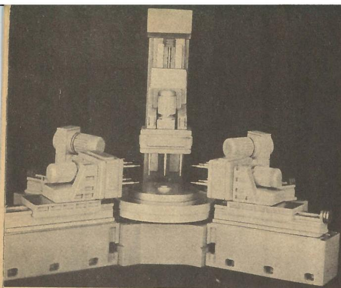
Из такого набора деталей, напоминающих детский «Конструктор», дизайнеры собирают различные модели агрегатных станков. Одна из них на снимке сверху.
