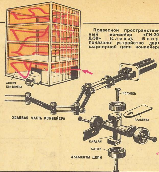
Подвесной пространственный конвейер «ГН-200 Д/50» (слева). Внизу показано устройство двухшарнирной цепи конвейера.
