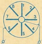
**Задача 5.** Конденсатор с электроемностью С зарядили до 80 в и с помощью рубильников Р<sub>1</sub> и Р<sub>2</sub> присоединили к конденсаторной батарее, состоящей из четырех таких же конденсаторов. Под каким напряжением окажется, и примерно, пятый конденсатор?
