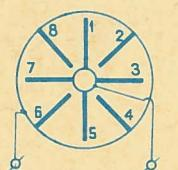
**Задача 5.** Конденсатор с электроемкостью  $C$  зарядили до 80 в и с помощью рубильников  $P_1$  и  $P_2$ , присоединили к конденсаторной батарее, состоящей из четырех таких же конденсаторов. Под каким напряжением окажется, к примеру, пятый конденсатор?
