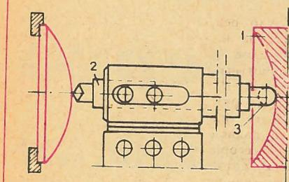
ру. При этом шток постепенно выдвигается вперед, и резец, повторяя путь ролика, протачивает заготовку. Заданные размеры и форма выдерживаются автоматически.
