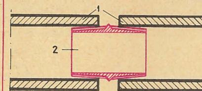
труб — продольные ребра высотой в 1 мм создают кольцевое уплотнение, непреодолимое для песка.
