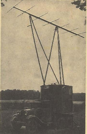
вольно проста. При отражении от летящего самолета длина радиоволны изменяется. Приемник, воспринимая радиоволны разной длины, выдает сигнал «бисений».
