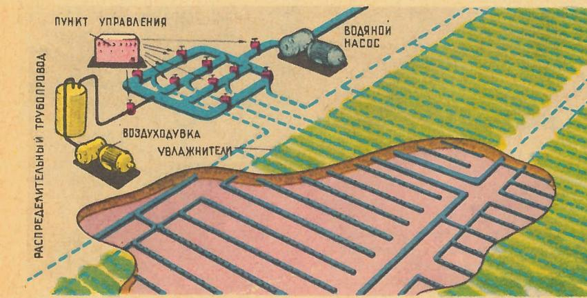
Принципиальная схема аэроводного подземного орошения.
