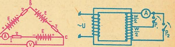
3. Три аккумуляторные батареи соединены так, как показано на рисунке. Электродвижущая сила каждой батареи составляет 12 вольт; сопротивление  $R = 4$  ома. Что покажут вольтметры  $V$  и  $\sim U$ ?
