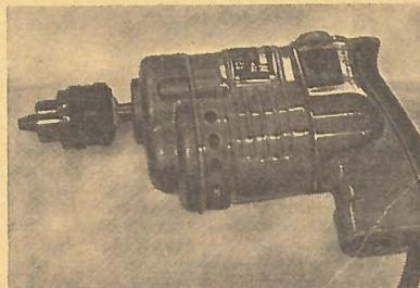
**Н**а выставке предметов бытовой техники и новых образцов, предстающих на серийное изготовление, внимание посетителей привлек «пистолет» — электродрель ЭД-12. Работает дрель от автомобильного аккумулятора, скорость вращения 1800 об/мин, вес 2 кг.
