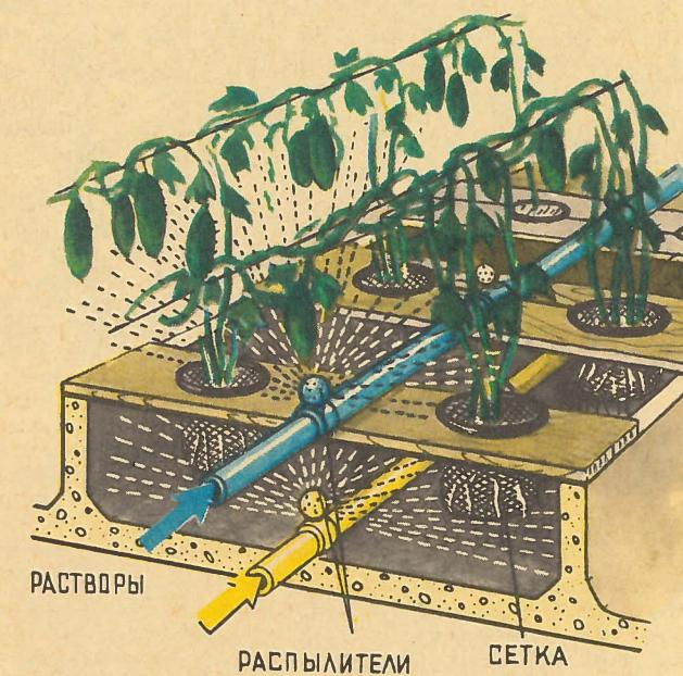
При аэропонном методе выращивания овощей и цветов функции грунта выполняют обычные трубопроводы. Из нижних — через определенные промежутки времени поступают к корням питательные вещества. Растворы этих веществ распыляются форсунками или по даются даже без них через решетчатые отверстия в трубе. А верхние трубопроводы служат для полива стеблей и листьев: ведь в «умытом с ног до головы» растении лучше протекают процессы фотосинтеза.
