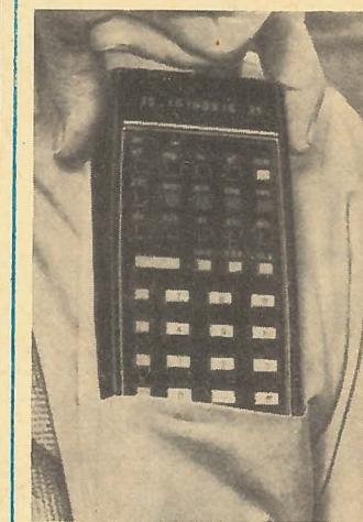
**КОМПЬЮТЕР В НАГРУДНОМ КАРМАНЕ.** Теперь уже трудно кого-нибудь удивить электронной вычислительной машиной, помещенной в портфеле. Одна из фирм пошла еще дальше — она сконструировала компьютер, легко умещающийся в нагрудном кармане рубашки! Размеры устройства 7,62 × 15,24 см, вес 255 г. Однако микросхема прибора эквивалентна «взрослой» ЭВМ, содержащей 30 тыс. транзисторов (Япония).
