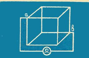
1. Из никромовой проволоки сделан каркас в форме куба. Сопротивление каждого ребра этой фигуры равно одному ому. Что покажет омметр, подключенный к точкам «а» и «в» куба?
