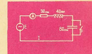
2. Цепь состоит из источника Э.Д.С. Е=220 в, активного сопротивления  $R_a = 30$  ом, индуктивного  $R_u = 40$  ом и емкостного  $R_e = 80$  ом. Увеличится или уменьшится показание амперметра, если мы рубильник Р замкнем?
