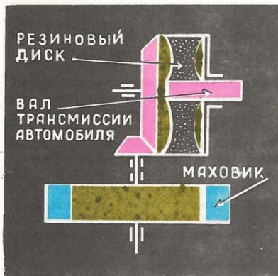
Рис. 2. Схема рекуператора с упругим звеном.
