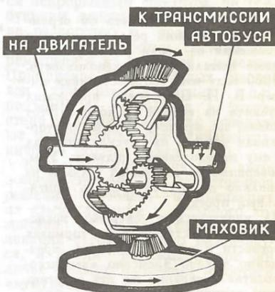
**Электрохимический рекуператор**, снабженный весьма большим маховиком, почти не применялся только для рекуперации, он служил обычно и для движения экипажа на перегонах. Впервые был применен швейцарской фирмой «Эрликон» на известных гиробусах (см. рис. 1).
