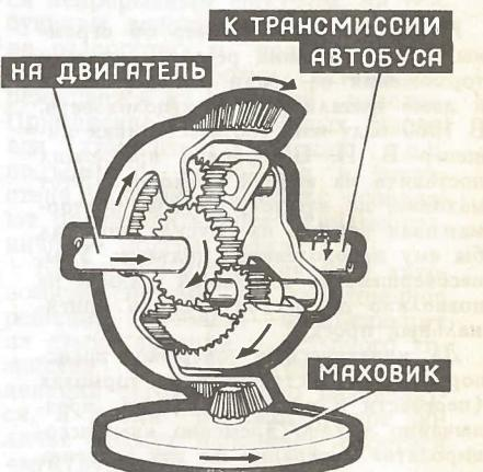
**Электромеханический рекуператор**, снабженный весьма большим маховиком, почти не применялся только для рекуперации, он служил обычно и для движения экипажа на перегонах. Впервые был применен швейцарской фирмой «Эрликон» на известных гибусах (см. рис. 1).
