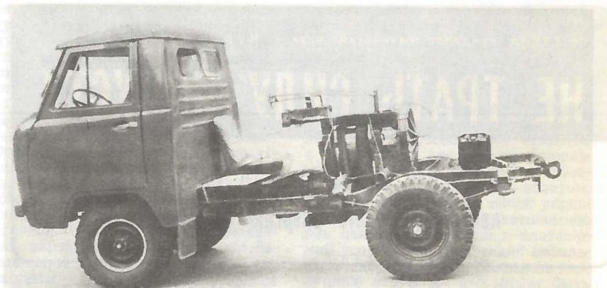
Экспериментальный автомобильный стенд для опробования рекуператора в режиме движения.
