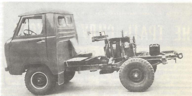
Экспериментальный автомобильный стенд для опробования рекуператора в режиме движения.
