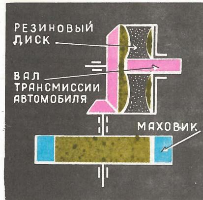
Рис. 2. Схема рекуператора с упругим звеном.
