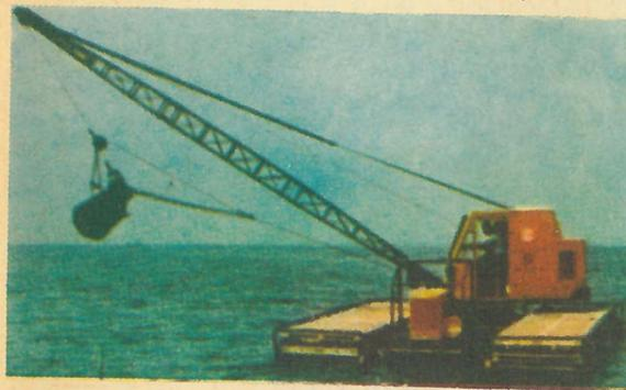
бесконечным канатом. Такой двигатель обеспечивает экскаватору высокую проходимость по мягким и болотистым почвам. Передвижение по воде осуществляется за счет перематывания гусениц. Скорость по суше 9 км/ч, по воде до 7 км/ч. На машине установлены 2 дизеля: один служит только для передвижения и расположен между понтонами, а другой приводит в действие механизмы драглайна (США).
