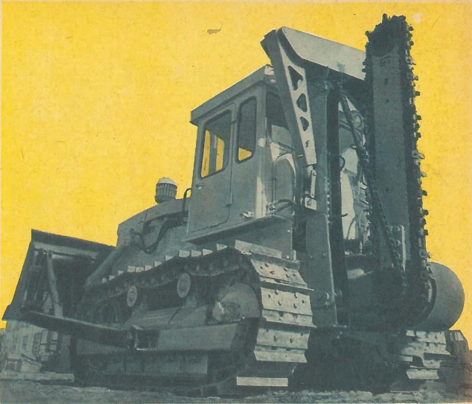
**ПРОДУКЦИЮ МАШИНОСТРОИТЕЛЬНОГО ЗАВОДА имени Б. Сардарова — трубокладчики, краны, землеройные машины — можно встретить на промыслах и строительных площадках, при проектировании магистральных газовых и нефтяных артерий, возведении плотин и рыхле траншей... Один из последних образцов — опытный агрегат, который одновременно может служить скалорезом, бульдозером или краном. Базируется комбинированная машина на мощном тракторе, от двигателя которого приводятся в работу все ее механизмы.**
