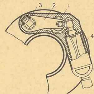
тель (4). Чтобы получить большой крутящий момент и повысить число оборотов шпинделя, червячная передача сочетается с двойным кулисным и храповым механизмами. Реакция, возникающая при закрутке болтов, гасится упором корпуса о трубу. Наличие в шпинделе муфты тарирования крутящего момента дает возможность контролировать его величину, обеспечивая высокое качество сборки.
