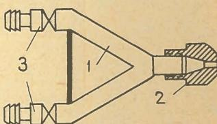
потоком сжатого воздуха, вода распыляется. Брызги, летящие с большой скоростью, счищают все отложения в трубах отопления. Давление воздуха в системе 4 атмосферы.
