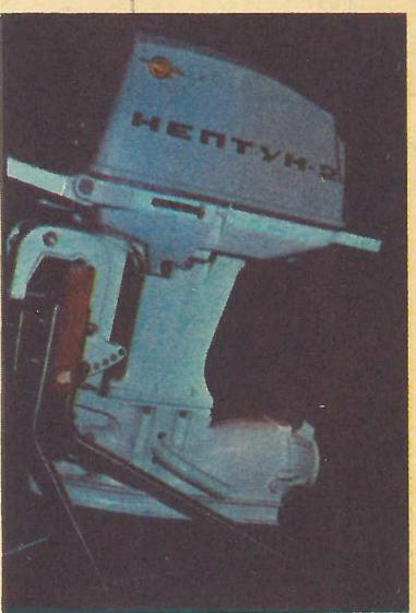
но и трансформаторы — от «Прибоя», поршневые кольца — от мотоцикла К-175, поршневые пальцы — от мотороллера «Тула». Только от «Москвы» к «Нептуну-М» подходят более 30 различных деталей. Фирма рекомендует использовать мотор новой модификации для буксировки воднолыжников. Действительно, на V Всесоюзных соревнованиях по этому виду спорта в 1971 году мотогоджа «Крым» с двумя «Нептунами-М» показала скорость 50 км/ч.
