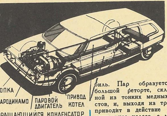
ТОПКА ПРИВОД ПАРОДИНАМО АВИГАТЕЛЬ КОТЕЛ ВРАЩАЮЩИЙСЯ КОНДЕНСАТОР
