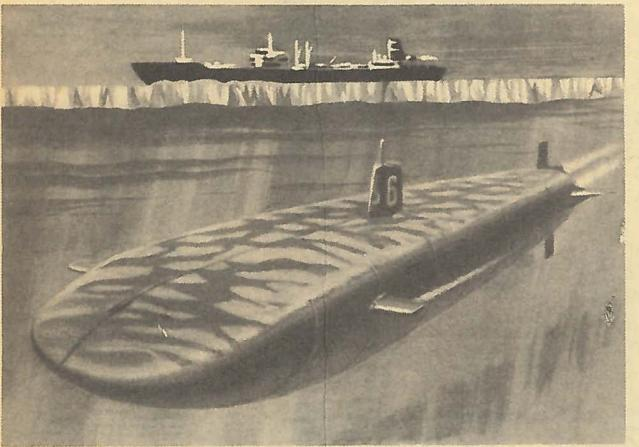
**ПОДВОДНЫЙ ТАНКЕР.** Для перевозки нефти с промыслов Аляски одна американская фирма разработала технический проект подводного танкера дедвейтом 170 000 т. Длина танкера 275 м, ширина 42,5 м, высота 26 м, скорость хода 18 узлов. Силовая установка — атомная, работающая на 2 гребных винта.
