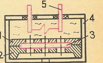
матрицей (1) и пресс-формой (2) закладывают деталь (3) и помещают в камеру (4), наполненную водой. Затем замыкают электроды (5). В воде возникает разряд, сопровождающийся ударной волной, которая и пробивает в детали отверстия.
