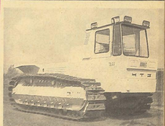
хода, гидромеханической трансмиссией для автоматического изменения тягового усилия в зависимости от нагрузки и другими усовершенствованиями, 24 из которых признаны изобретениями. Скорость такой машины до 18 километров в час. В кабине — кондиционированный воздух; стены ее защищены тепловой и звуковой изоляцией.
