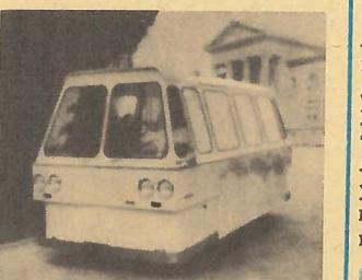
Машина весит около 1500 кг (из них 500 кг — аккумуляторная батарея). Так как проектная скорость автобуса не превышает 10—15 км/ч, он может быть использован в качестве внутриводского транспорта, для обслуживания торговых центров, лагерей и т. п. Электроавтобус рассчитан на непрерывную работу в течение 8 часов при 500 и более остановках и запусках. (США).
