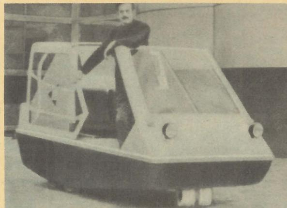
бил сконструирован английским инженером Катлером. Он отличается от всех прочих конструкций тем, что поставлен не на колеса, а на ролики. По мнению Катлера, это обеспечит машине повышенную проходимость, а малый вес позволит ей плавать. Дверцы автомобиля сделаны скользящими.
