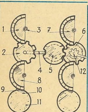
Кинематическая схема механизма вычислительной машины Якобсона.
