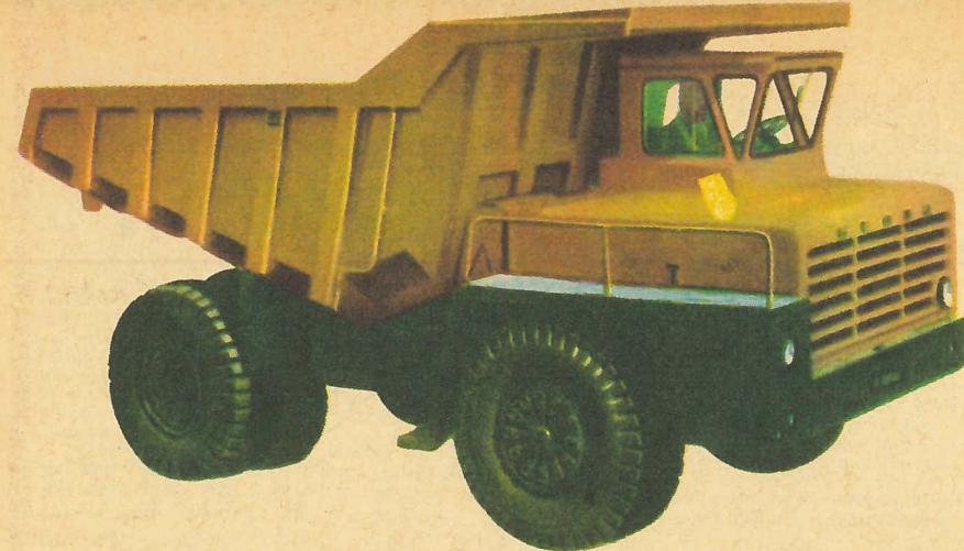
Автомобиль-самосвал БелАЗ-540 грузоподъемностью 30 т. Полный вес автомобиля — 51 т. Максимальная скорость с полной нагрузкой на горизонтальном участке дороги — 55 км/час. Номинальная мощность четырехтактного дизельного двигателя при 1650 об/мин — 375 л. с. Удельный расход топлива — 175 г/л. с. ч. Самосвал имеет отличную устойчивость и может разворачиваться на площадке размером 18×18 м.
