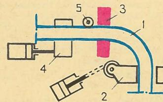
Труба поджимается кареткой (4). Ролик (5) не только направляет ее движение, но и воспринимает реакцию от приложенного изгибающего момента. Чтобы уменьшить сопротивление трубы изгибу и усилить осевой поджим, сектор гибочной головки соединен со штоком гидроцилиндра.
