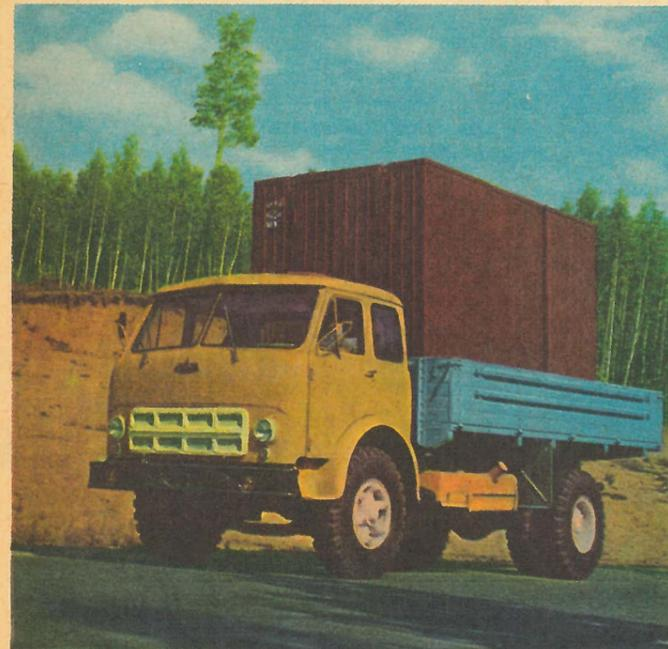
Грузовой автомобиль МАЗ-500А грузоподъемностью 9 т. Полный вес автомобиля — 12,5 т, максимальная скорость с полной нагрузкой — 85 км/час. Номинальная мощность двигателя при 2100 об/мин — 200 л. с. Минимальный радиус разворота по внешним колесам — 3,5 м.
