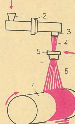
засасывается дутьевым устройством (5). Скоростной поток вытягивает из густой массы волокна (6) и напыляет их на поверхность врачающегося барабана (7), совершающего дополнительно возвратно-поступательное движение. После того как полотно достигнет нужных размеров, его режут и снимают с барабана. Меняя условия формования — расход расплава, степень нагрева, скорость распыления и др., получают изделия различного вида и сорта.
