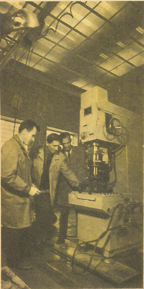
ков. Назначение их — окончательная обработка и доводка цилиндрических и конических отверстий и деталей сложной конфигурации из твердых сплавов и закаленных сталей.
