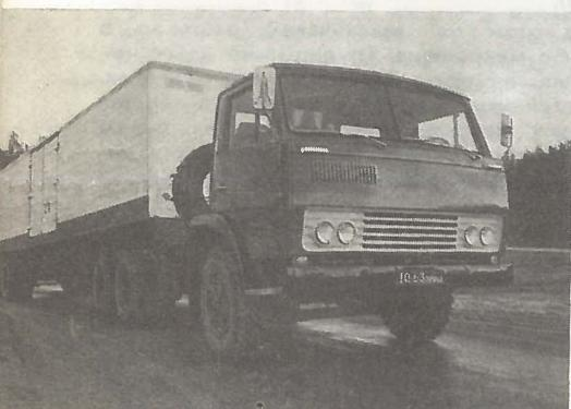
полуприцеп-фургон — Одесского сборочного (ОдАЗ-9770), дизельный двигатель мощностью 210 л. с. — Ярославского моторного завода (ЯМЗ-740). Место создания — отдел главного конструктора Московского завода имени Лихачева. При надлежит автопоезд будет семейству автомобилей КамАЗ. Выпускать автопоезда в этой пятилетке будут на Камском автомобильном заводе, который сейчас только строится.
