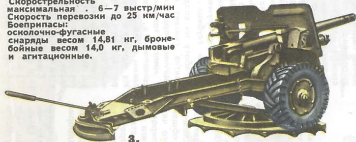
4. 17-фунтовая (76,2-мм) противотанковая пушка. Состояла на вооружении дивизионных и корпусных полков противотанковой артиллерии английской армии.
