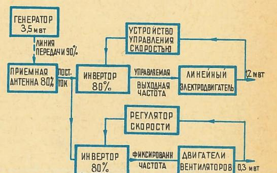
Блок-схема энергетической установки аэропоезда. Инвертор преобразует постоянный ток в переменный.
