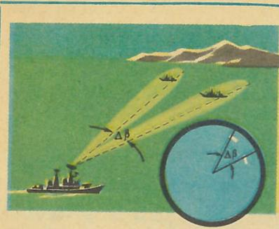
Определение разрешающей способности по направлению — минимального угла между направлениями на два объекта, находящиеся на одной и той же дальности.
