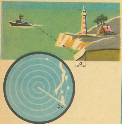
Схема образования радиолокационного изображения. Станция с высокими разрешающими способностями позволила наблюдать отдельные, близко расположенные цели.
