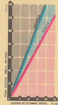
Зависимость времени удвоения веса орбитальной станции за счет накопления жидкого кислорода или воздуха от удельного веса бортовой энергетической установки.
