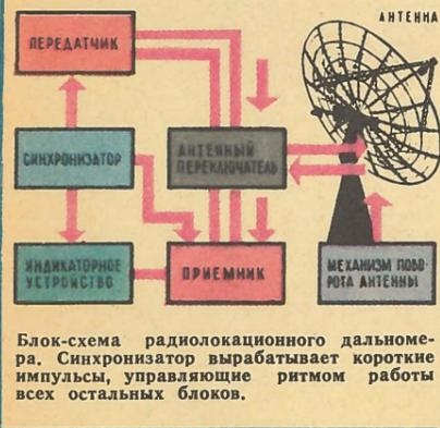
Блок-схема радиолокационного дальнометра. Синхронизатор вырабатывает короткие импульсы, управляющие ритмом работы всех остальных блоков.
