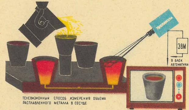
ТЕЛЕВИЗИОННЫЙ СПОСОБ ИЗМЕРЕНИЯ ОБЪЕМА РАСПЛАВЕННОГО МЕТАЛЛА В СОСУДЕ
