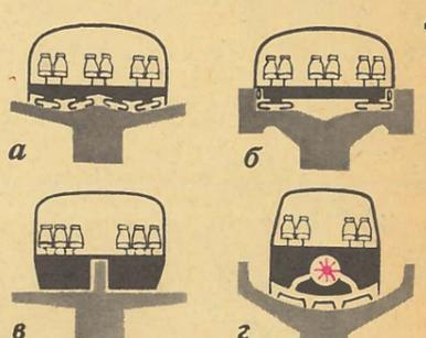
Рис. 4. Варианты для аэропоездов (а, б — американского «Ховеркара»; в — французского «Аэротрейна»; г — по французскому патенту).
