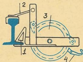
**В ТЕХ СЛУЧАЯХ, КОГДА ПРИ РЕМОНТЕ ЖЕЛЕЗНОДОРОЖНЫХ** путей приходится менять шпалу, прибегают к помощи нового приспособления. Его закрепляют на одном из рельсов передним концом каркаса 1 за низ и захватом 2 за головку рельса. Под другую нитку пути пропускают конец троса и крюком 4 зацепляют за шпалу. Трос свернут на дисковом барабане, который соединен с храповым колесом 3. Колесо поворачивают, трос натягивается и вытаскивает шпалу.
