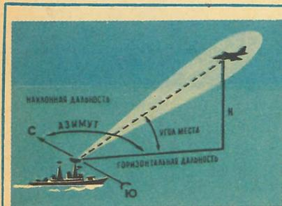
Координаты цели, определяемые при радиолокационном наблюдении: наклонная дальность (пенг), азимут (курсовой угол) и угол места цели.
