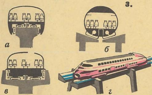
Рис. 3. Варианты пути для английского двухэтажного аэропоезда «Ховеркар».
