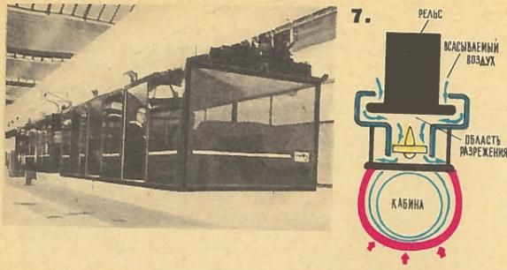
Рис. 7. Французский аэропоезд «Урба». Слева — фотография, справа — схема подвешивания вагона на «вакуумной» подушке.
