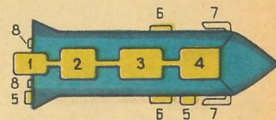
Рис. 1. Схема устройства ионосферной лаборатории «Янтарь»: 1 — газовый плазменно-ионный двигатель; 2 — блок управления работой двигателя и измерительного комплекса; 3 — бортовые источники питания; 4 — радиотелеметрическая аппаратура; 5 — ионные ловушки; 6 — электростатические флюксометры для измерения напряженности электрического поля на поверхности лаборатории; 7 — антенны; 8 — ионизационные манометры.
