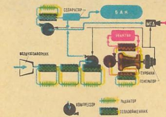
Рис. 2. Одна из предлагаемых схем летательного аппарата с накоплением внешней массы.
