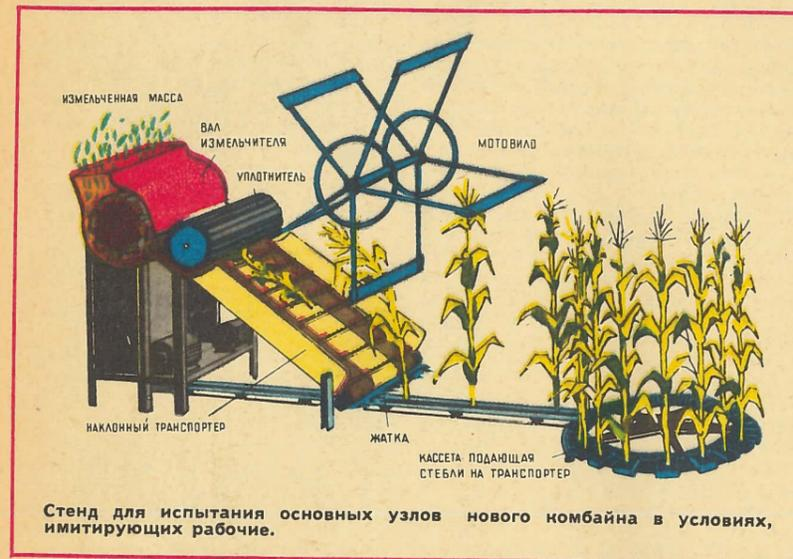
Стенд для испытания основных узлов нового комбайна в условиях, имитирующих рабочие.
