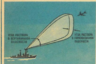
Антенна формирует радиолуч, имеющий малый раcтвор (ширину) в горизонтальной плоскости и относительно большой — в вертикальной. Антенна вращается — так осуществляется круговой обзор.
