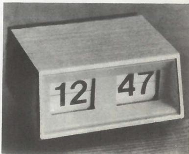
**В МЕСТО ОБЫЧНОГО ЦИФЕРБЛАТА И СТРЕЛОК** у настольных электронномеханических часов — световое табло. Часы работают от батареи для карманного фонаря и не требуют перезарядки в течение целого года. Они удобны в обращении и обладают высокой точностью хода — суточное отклонение не превышает 20 сек.
