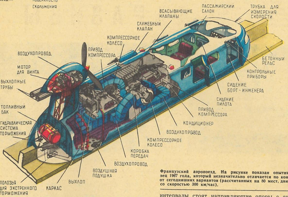
Французский аэропоезд. На рисунке показан опытный образец 1967 года, который незначительно отличается по конструкции от сегодняшних вариантов (расчетанных на 80 мест, движущихся со скоростью 300 км/час).
