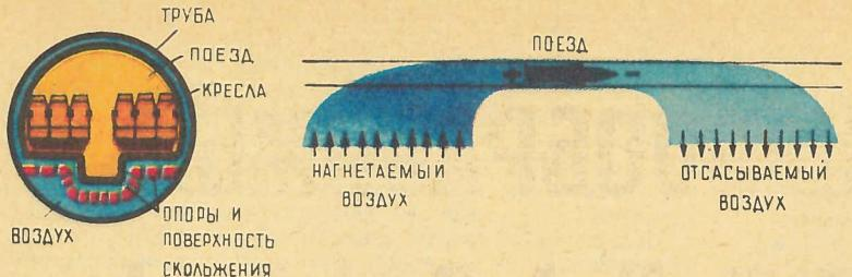
Пневматический поезд окружен тонкой воздушной пленкой. За счет разности давлений он мчится в прочной стеклянной трубе. Пассажиры могут беспрепятственно любоваться окружающим пейзажем.
