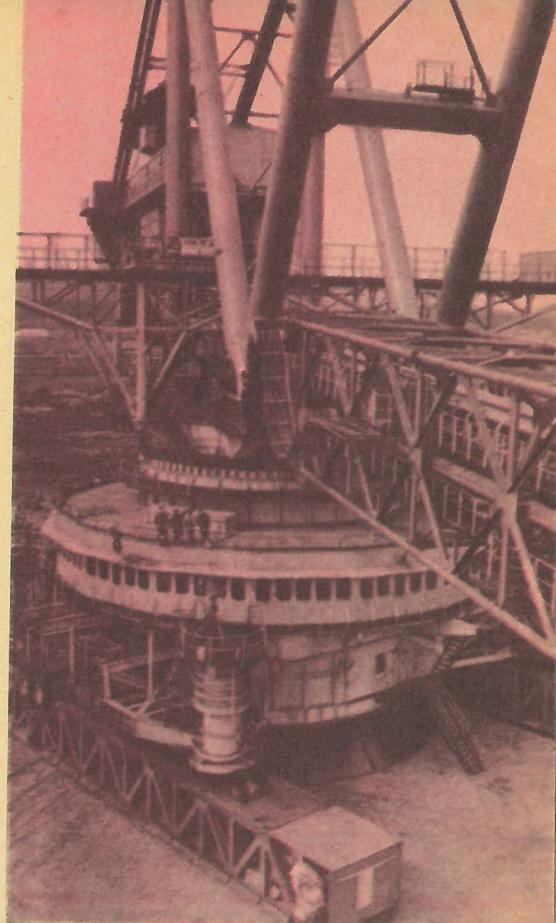
**Э**ТОТ МОЩНЫЙ ВСКРЫШНОЙ КОМПЛЕКС ИЗГОТОВЛЕН на Ново-Краматорском заводе, а собран на месте в Морозовском угольном разрезе. Ежегодная добыча угля там 2750 тыс. т! Запасы топлива могут быть исчерпаны только через 25—30 лет.
