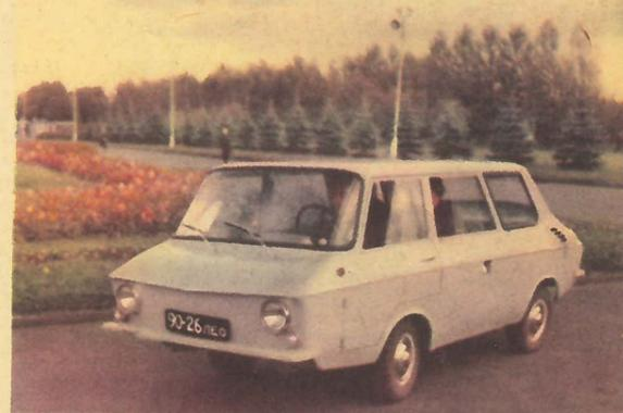
Стеклопластик становится популярным материалом для кузовов машин-самодельки. Его замечательные свойства позволили ленинградцу Г. Федорову создать этот «микроавтобус».
