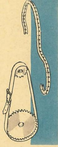
такого же диаметра шкивы. И оказалось, что «старый конь» не так уж плох. С ременной передачей «Рига-3» идет мягче, причем отсутствуют рывки при малых оборотах двигателя и при неосторожном троганье с места. После эксперимента полагается делать выводы — я решил ограничиться констатацией факта. Поживем — увидим...
