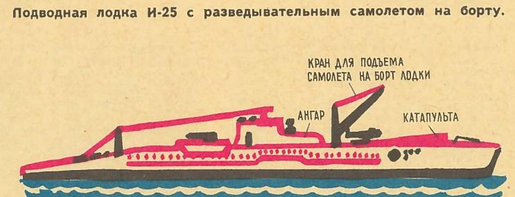
Подводная лодка I-25 с разведывательным самолетом на борту.
