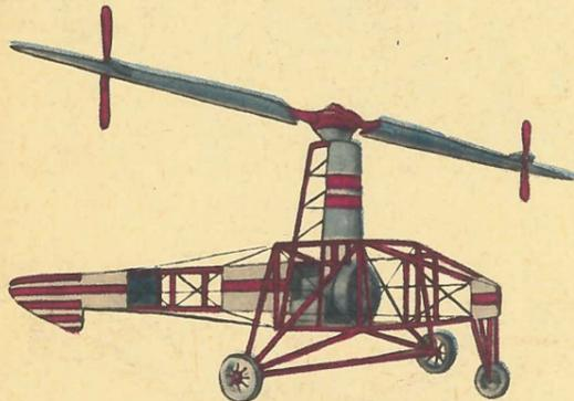
По идее инженера Вельнера (известного своими теоретическими работами в области механики несущего винта вертолета) ротор приводится во вращение винтомоторными установками на лопастях. Такая схема, не выдержав испытания временем, прочно утвердилась лишь в вертолетном авиамodelизме.
