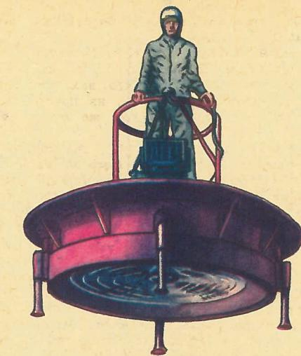
«Летающая платформа» — один из примеров решения проблемы компактного аппарата с вертикальным взлетом и посадкой. Увлечением подобным вариантом классического вертолета авиационный мир «переболел» в конце 50-х — начале 60-х годов.
