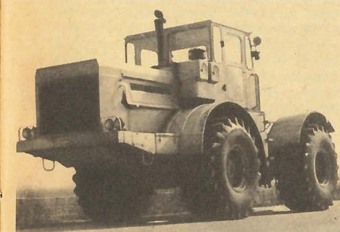
Государственная комиссия приняла модель нового трактора К-701 и рекомендовала Кировскому заводу выпустить опытную партию этих машин для проведения эксплуатационных испытаний. К-701 отличается от своих предшественников более мощным двигателем (280 л. с.), позволившим значительно увеличить тягу на крюке, улучшить динамику и повысить на 20% норму выработки.
