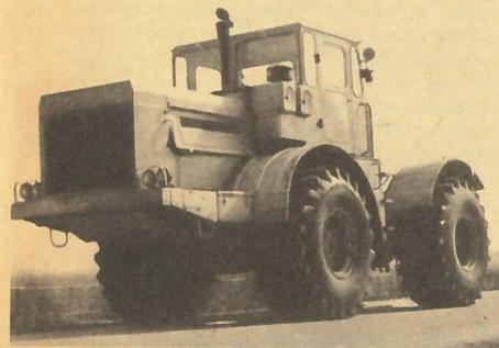
**ГОСУДАРСТВЕННАЯ КОМИССИЯ ПРИНЯЛА МОДЕЛЬ НОВОГО** трактора К-701 и рекомендовала Кировскому заводу выпустить опытную партию этих машин для проведения эксплуатационных испытаний. К-701 отличается от своих предшественников более мощным двигателем (280 л. с.), позволившим значительно увеличить тягу на крюке, улучшить динамику и повысить на 20% норму выработки.
