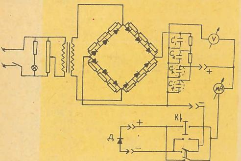
**Н**А ЗАВОДЕ МЕДИЦИНСКОГО ОБОРУДОВАНИЯ РАЗРАБОТАН и внедрен прибор для проверки диодов. С его помощью подбирают нужные полупроводники, имитируют условия их работы, измеряют основные параметры, испытывают по обратному току и т. п. В корпусе прибора смонтирован выпрямитель. На панели — ручка обратного напряжения, выключатель сети, сигнальная лампа, миллиамперметр и вольтметр, зажимы для подсоединения диода. Точное знание характеристик диодов снижает потери от брака.
