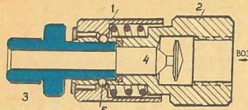
**О**ДНО ДВИЖЕНИЕ, И МОЛОТОК, ДРЕЛЬ ИЛИ ЛЮБОЙ другой инструмент отсоединяется от воздушной магистрали. Нужно только одной рукой отодвинуть обойму 1 до упора в заплечики корпуса 2, а другой взяться за штудер 3. Шарики 5 выйдут из кольцевой канавки штудера, соединенного с инструментом, и освободят его. Клапан 4 струей сжатого воздуха плотно прижмется к седлу корпуса и закроет отверстие воздухопровода, а пружина 6 вернет обойму в первоначальное положение.
