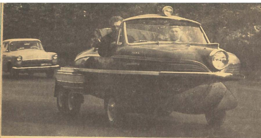
**А**ВТОМАШИНУ «КАМА» МОЖНО ВСТРЕТИТЬ ТОЛЬКО НА улицах Перми. Внешне она напоминает лодку: узкий нос, трехлопастный винт под кузовом. По асфальту машина катит на шести колесах, не уступая в скорости «Запорожцу», на реке она соперничает с «Ракетой». Если на две пары задних колес надеть гусеничные ленты, а передние поставить на лыжи — «Каме» нипочем снежная целина.
