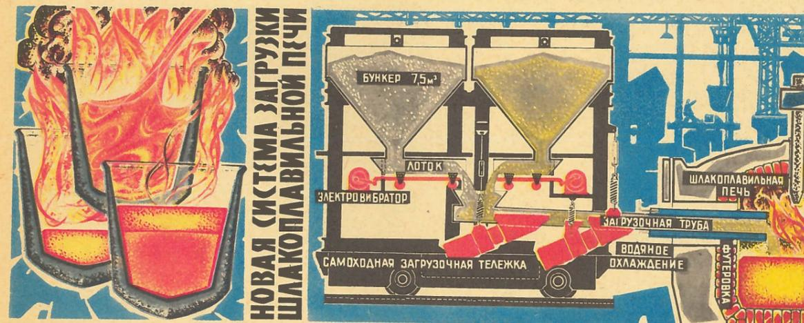
Вначале попытались использовать для этого обычную 30-тонную электропечь. Шихту, естественно, загрузили, как руду, сверху. Но вот включили электродугу, и печь превратилась в трубу с хорошей тягой. Наклонили агрегат, чтобы вылить в ковш расплавленный шлак, — освобожденная от него угольная футеровка встретилась с кислородом воздуха и стала подгорать. Каждые две-три недели — ремонт.
