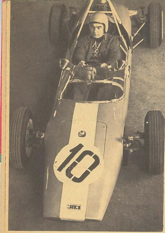
**БАЗОЙ ГОНОЧНОГО АВТОМОБИЛЯ «ЮНОСТЬ» ПОСЛУЖИЛ «Запорожец» модели ЗАЗ-966. Двигатель форсирован, его мощность доведена до 50 л. с. На Всесоюзных шоссейно-кольцевых гонках в Ленинграде и Минске автомобиль развил скорость 165—170 км/час.**
