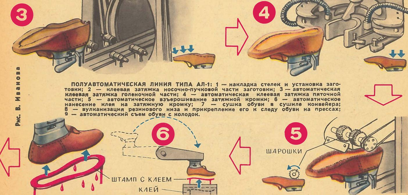
ПОЛУАВТОМАТИЧЕСКАЯ ЛИНИЯ ТИПА АЛ-1: 1 — накладка стелек и установка заготовки; 2 — kleевая затяжка носочно-пучковой части заготовки; 3 — автоматическая kleевая затяжка голеностопной части; 4 — автоматическая kleевая затяжка пятонной части; 5 — автоматическое возвращение затяжной кромки; 6 — автоматическое нанесение kleя на затяжную кромку; 7 — сушка обуви в сушиле конвейера; 8 — вулканизация резинового низа и прикрепление его к следу обуви на прессах; 9 — автоматический съем обуви с колодок.
