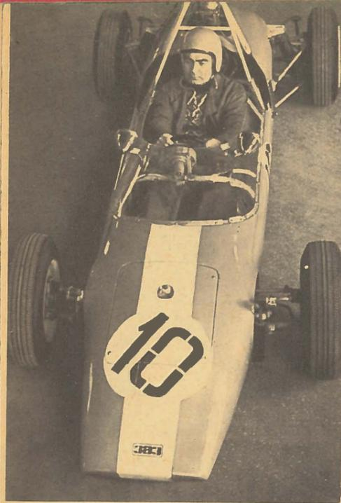
**БАЗОЙ ГОНОЧНОГО АВТОМОБИЛЯ «ЮНОСТЬ»** ПОСЛУЖИЛ «Запорожец» модели ЗАЗ-966. Двигатель форсирован, его мощность доведена до 50 л. с. На Всесоюзных шоссейно-кольцевых гонках в Ленинграде и Минске автомобиль развил скорость 165—170 км/час.
