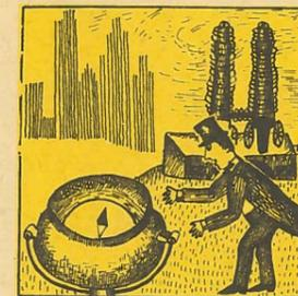
большой в мире. Подкову, составленную из двух больших пушек, соединенных переключателем, он обмотал хорошо изолированной телеграфной проволокой. Ток вырабатывается динамо-машиной. Утверждают, что магнит может действовать на судовые компасы на расстоянии десяти миль и таким образом препятствовать приближению к берегу неприятельских судов. Ряд таких электромагнитов, расположенных вдали от вала форта, вырвал бы ружья из рук наступающих солдат. 1895 г.
