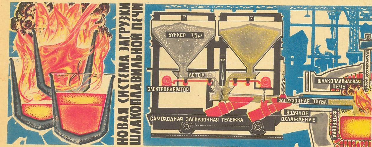
Вначале попытались использовать для этого обычную 30-тонную электропечь. Шихту, естественно, загружали, как руду, сверху. Но вот включили электродугу, и печь превратилась в трубу с хорошей тягой. Наклонили агрегат, чтобы вылит в ковш расплавленный шлак, — освобожденная от него угольная футеровка встретилась с кислородом воздуха и стала подгорать. Каждые две-три недели — ремонт.
