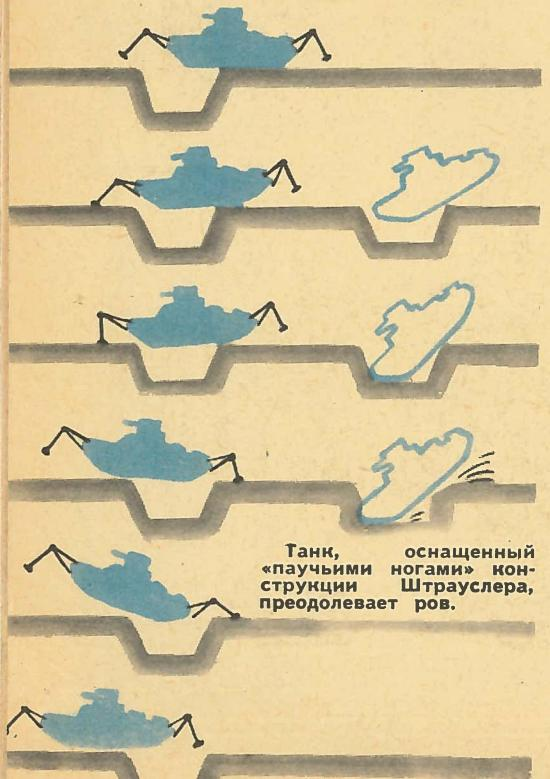
Танк, оснащенный «паучьими ногами» конструкции Штрауслера, преодолевает ров.
