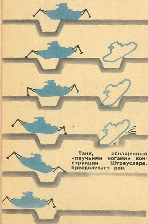
Танк, оснащенный «паучьими ногами» конструкции Штрауслера, преодолевает ров.
