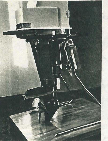
**ФАМИЛЬНАЯ ДИНАСТИЯ ЛОДЧНЫХ МОТОРОВ «ВИХРЬ» продолжается. Как только 20-сильный «родитель» уйдет на «пенсию», на конвейер встанут 25- и 30-сильные. Как и следовало ожидать, молодые «Вихри», несмотря на большую мощность, не столь тяжелы. Вместо 48 кг первый весит 42, а второй 44 кг. Этого удалось добиться за счет отливки тонкостенных деталей под давлением и заменой чугунных цилиндров алюминиевыми блоками.**
