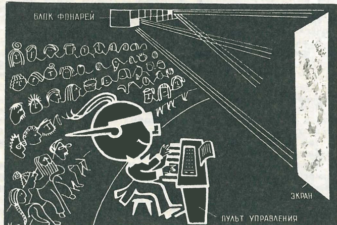
Цветомузыкальная установка, управляемая человеком (конструкция Ю. Правдюка).
