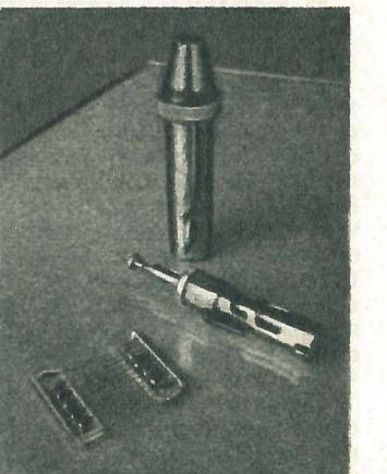
**САПФИРЫ НА МЕТРЫ!** В лаборатории фирмы «Тайлок» разработан способ получения нитей монокристалла сапфира тоньше человеческого волоса, обладающих прочностью на разрыв порядка 20 тыс. кг на  $\text{cm}^2$  и модулем эластичности — до 5 млн. кг на  $\text{cm}^2$ . На приводимой фотографии показан «моток» сапфировой нити длиной около 3 м, а также монокристаллы сапфира, выращенные в виде лент, уголков, трубок и других профилей (США).
