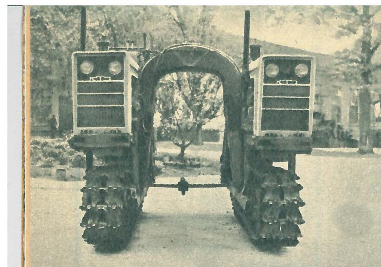
**НЕОБЫЧЕН НА ВИД ТРАКТОР Т-54Д.** Две независимые установки, соединенные жесткой арочной рамой, делают его похожим на «сухопутный катамаран». Каждая установка состоит из двигателя, трансмиссии, одногусеничного движителя и у каждой — свое рабочее оборудование.
