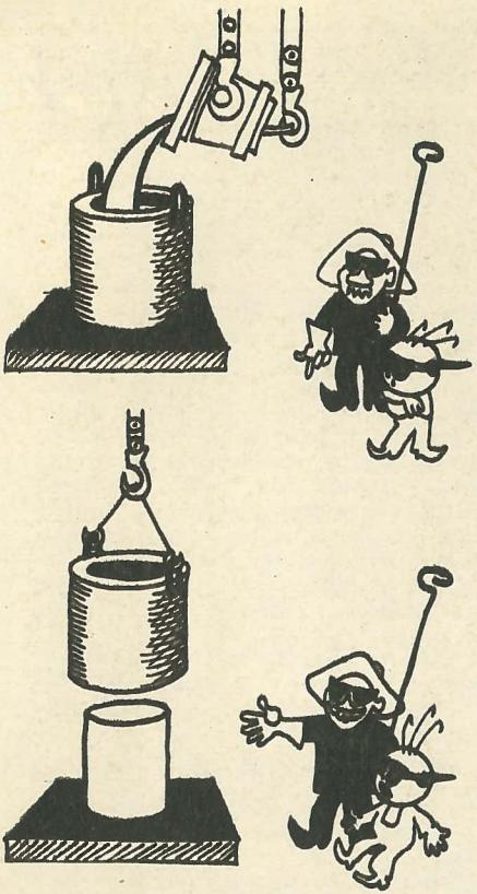
Тонкостенная стальная труба вместо тяжелой чугунной изложницы.
