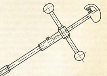
вертывают гайки и винты, сверлят, зенкуют, развертывают отверстия. На верхнем конце стержня ключа, на шариковом подшипнике, насыжен шаровой упор. На нижнем стержне винтом крепятся торцовые ключи, отвертки, сверлильный патрон. Чтобы заставить ключ вращаться, берутся за упор и ударяют или толкают шар одной из горизонтальных ручек.
