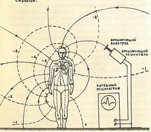
Рис. 2. Измерение электрического поля сердца.
