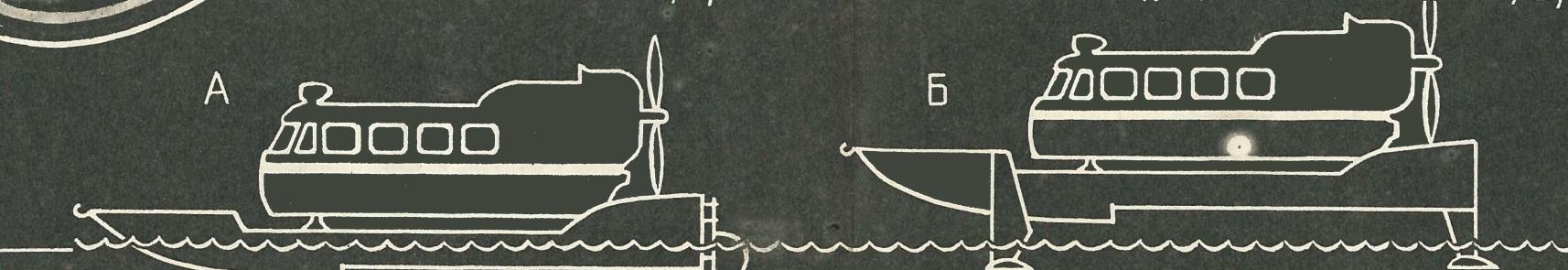
ДВИЖЕНИЕ ПО СКЛОНОМ /А/ И ПРЕОДОЛЕНИЕ ПОДЪЕМОВ /Б/
