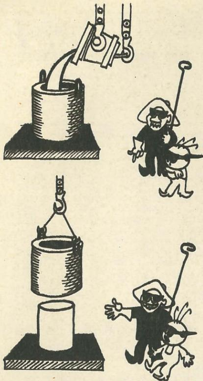
Тонкостенная стальная труба вместо тяжелой чугунной изложницы.
