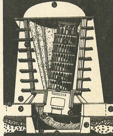
ПОСЛЕДОВАТЕЛЬНОСТЬ ОПЕРАЦИЙ: 1–2. Укладка колецного основания; 3. Сборка башни; 4. Установка наружных панелей башни; 5. Покрытие; 6. Термоизолирующие прокладки (в три слоя); 7. Наполнение водой; 8. Замораживание; 9. Сборжение круглого цоколя; 10. Выемка грунта и усиление башни в виде ступенчатой лестницы; 11. Уплотнение грунта; 12. Уплотняющий слой; 13. Укладка нового фундамента; 14. Освобождение и нивелирование участка после осушения и демонтажа опалубки.
