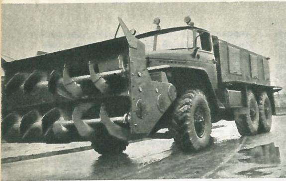
**ЭТОЙ ЗИМОЙ АВТОСТРАДЫ БУДУТ ЧИСТЫ ОТ ЗАНОСОВ.** Новые машины Д-902 — шнекороторные снегоочистители за час отбрасывают 1200 т снега на расстояние до 45 м. Ширина очищаемой полосы — 2,8 м.
