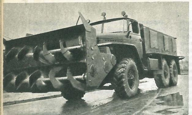
**Э**ТОЙ ЗИМОЙ АВТОСТРАДЫ БУДУТ ЧИСТЫ ОТ ЗАНОСОВ. Новые машины Д-902 — шикоротные снегоочистители за час отбрасывают 1200 т снега на расстояние до 45 м. Ширина очищаемой полосы — 2,8 м.
