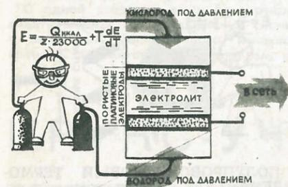
**ТОПЛИВНЫЙ ЭЛЕМЕНТ.**  $Q$  — теплота реакции,  $Z$  — валентность ионов,  $T$  — температура,  $\frac{dE}{dt}$  — температурный коэффициент ЭДС.
