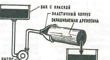
хранившую высокую влажность древесину нарезают на полутораметровые заготовки и через них прогоняют красящий раствор.
