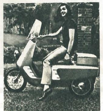
**ТРЕХКОЛЕСНЫЙ ЭЛЕКТРИЧЕСКИЙ МОТОРОЛЛЕР.** Трехколесный мотороллер «Трилек» — одно из решений проблемы уменьшения шумности и загрязнения воздуха в городах. У него низко расположенный центр тяжести, удобное регулируемое седло и свинцовый аккумулятор, заряжаемый от сети.
