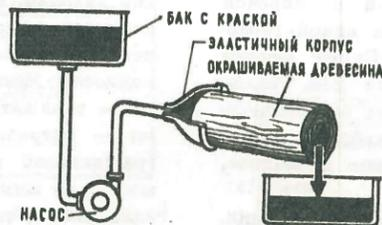
хранившую высокую влажность древесину нарезают на полутораметровые заготовки и через них прогоняют красящий раствор. Из бака его нагнетают насосом в эластичный конус, плотно охватывающий торец чурака. Благодаря давлению он проходит через весь объем и вместе с соком сливается с другого конца чурака. Время окрашивания 5—6 минут, давление 4—6 атмосфер.
