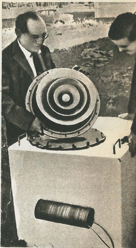
Профессор Гавро с прибором для градуирования инфразвуковых частот, улавливаемых детекторами.
