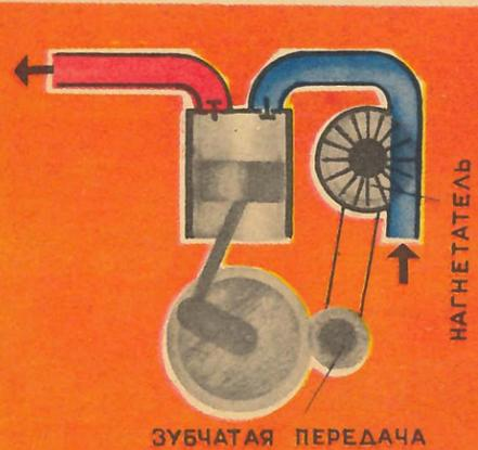
4. СХЕМА ТУРБОНАДДУВА
