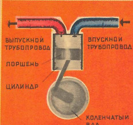
2. ОБЫЧНАЯ СХЕМА ДВИГАТЕЛЯ С ТЩАТЕЛЬНО ОБРАБОТАН. ТРАКТАМИ
