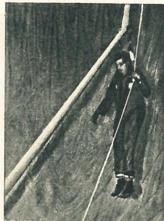
**ПНЕВМАТИКА НА ПОЖАРЕ.** Оригинальный подъемник для пожарных разработан голландскими специалистами. Устройство представляет собой систему широких роликов, обжимающих воздушный шланг. Волна накачиваемого воздуха расправляет шланг и гонит подвеску с пожарным вверх. Когда воздух выпускают, подвеска плавно снижается. Ее скорость регулируется скоростью нагнетания или выпуска воздуха (Нидерланды).
