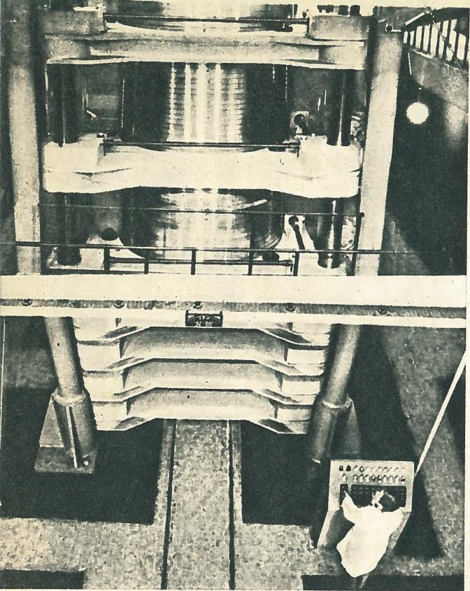
В ИНСТИТУТЕ МЕТРОЛОГИИ ИМЕНИ Д. И. Менделеева закончен монтаж гигантской установки для силовых измерений. По высоте она превосходит трехэтажное здание (см. фото слева). Новый государственный эталон позволяет производить измерения в диапазоне от 1 до 100 т с точностью до двухтысячных долей процента.
