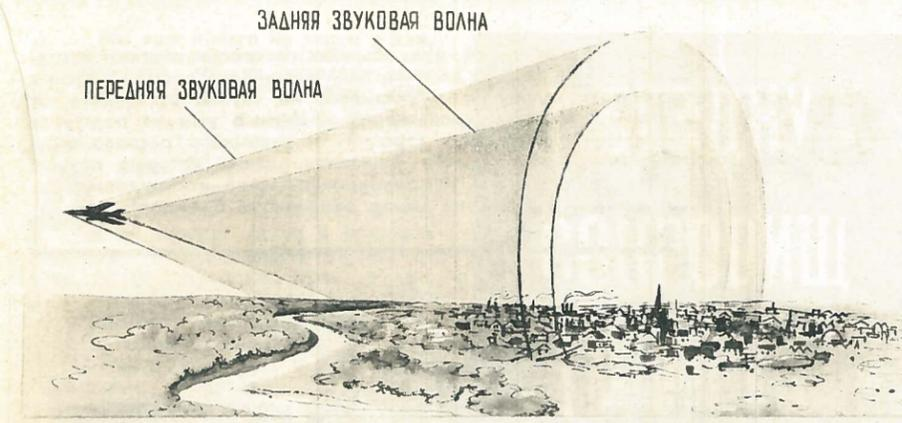
На рисунке коническая ударная волна, возникающая во время сверхзвукового полета, следует за самолетом и пересекается с поверхностью.
