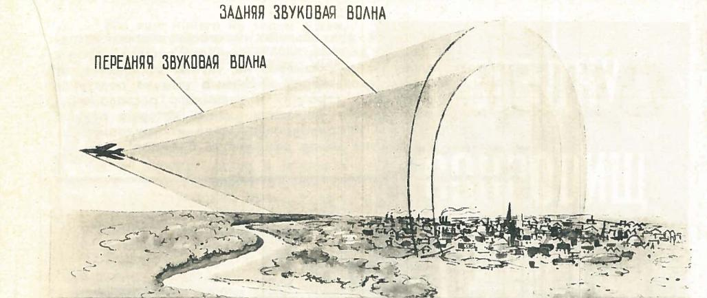
На рисунке коническая ударная волна, возникающая во время сверхзвукового полета, следует за самолетом и пересекается с поверхностью.
