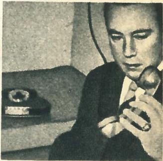
**БЕЗ ШНУРА И ПРОВОДОВ.** Такой телефон сконструирован в Италии. Трубка и корпус связаны между собой двусторонним транзисторным приемно-передающим устройством. Радиус действия беспроводного телефона — около 20 м (Италия).
