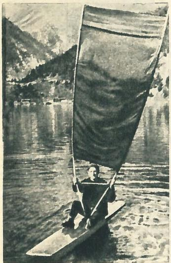
**ПОРТАТИВНЫЙ ПАРУС.** Этот оригинальный «парусник» создан любителем. Водитель, сидя на широкой (60 см) плавательной доске или в гоночной одиночке, держит рамку с парусом обеими руками. Для маневрирования рамку нужно соответственным образом поворачивать относительно ветра. Для торможения служит коромое весло (ФРГ).
