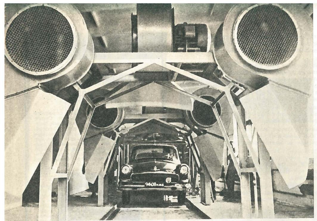
МЕХАНИЗИРОВАННАЯ МОЙКА ЛЕГКОВЫХ МАШИН. Весь «туалет» завершается за 2–3 мин. После душа машину мгновенно высушивают шесть мощных вентиляторов.
