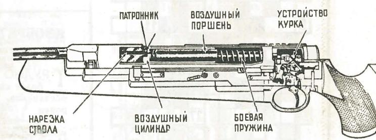
Разрез модели воздушной винтовки «150».
