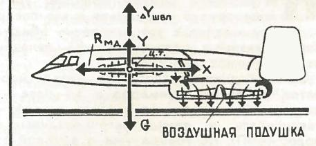
1Б. ШАССИ НА ВОЗДУШНОЙ ПОДУШКЕ
