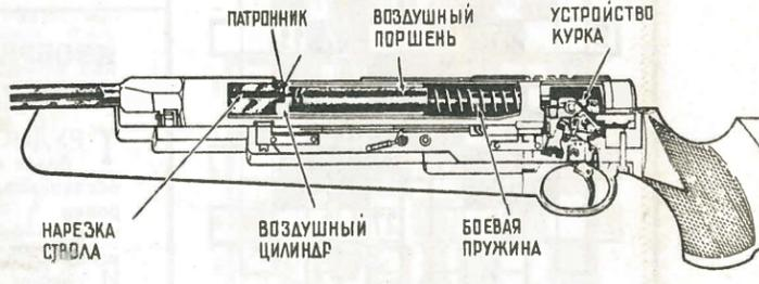
Разрез модели воздушной винтовки «150».
