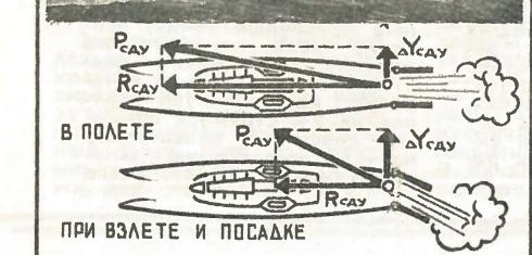
3В. СТРУЙНАЯ ДВИГАТЕЛЬНАЯ УСТАНОВКА
