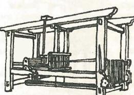
Ткацкий станок с горизонтальной рамой.
