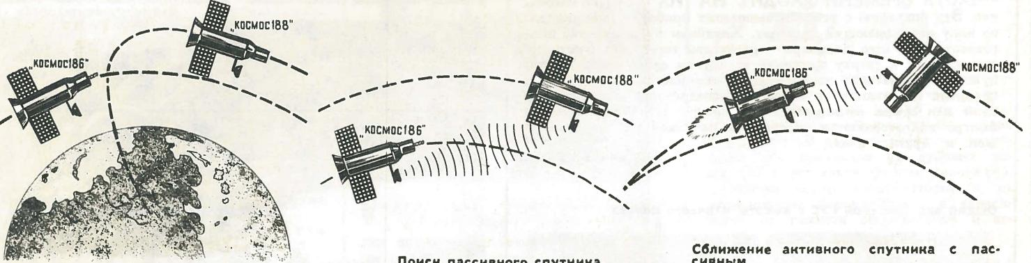
Поиск пассивного спутника.
