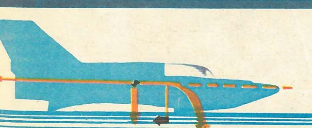
2 Центр тяжести расположен сравнительно далеко от кормы. Поэтому сила тяги двигателя может «загнуть» нос лодки. Кормовой поплавок запроектирован для уменьшения угла атаки.
