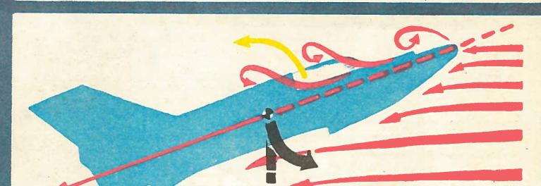
4 Лодка потеряла контакт с поверхностью воды. Плоский нос не препятствует поступлению воздуха под корпус, «невольно» становится рулём высоты в положении «подъем». Под корпусом образовалась сильная сжатая воздушная подушка. Плоский нос и...
