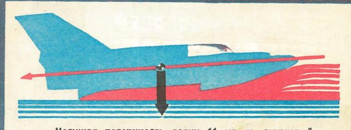
2 Несущая поверхность лодки 11 кв. м, стартовый вес — 2600 кг. Нагрузка на крылья-поплавки составляет 230—240 кг/м<sup>2</sup>.
