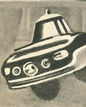
словакии. Она послушна в управлении и, несмотря на два колеса, отлично сохраняет равновесие в пути. Максимальная скорость одноместной машины — 25 км/час (Чехословакия).
