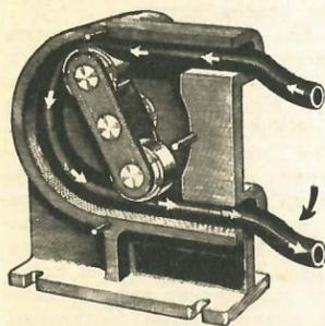
**«СУХОЙ» НАСОС.** Очень простую конструкцию насоса для жидкостей, остающегося всегда сухим, выпускает фирма «Рандольф». Перекачиваемая в нем жидкость нигде не соприкасается с деталями насоса. Производительность — 1000 л жидкости в час (США).
