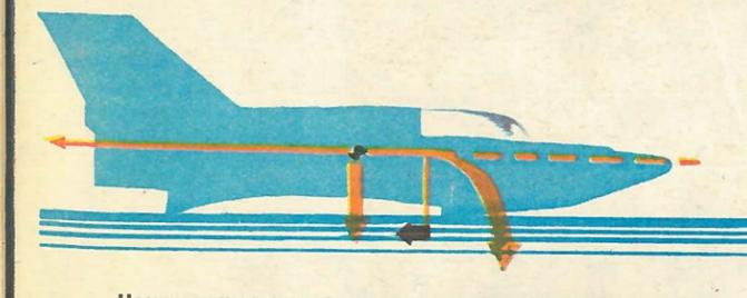
4 Центр тяжести расположен сравнительно далеко от нормы. Поэтому сила тяги двигателя может «загнуть» нос лодки. Кормовой поплавок запроектирован для уменьшения угла атаки.
