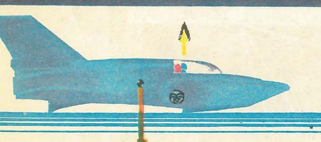
1 «Блюберд» статически устойчива. Центр тяжести расположен между точками опоры — транцем и поплавками.
