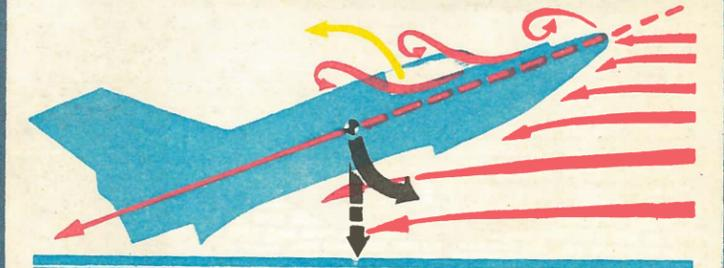
5 Лодка потеряла контакт с поверхностью воды. Плоский нос не препятствует поступлению воздуха под корпус, «невольно» становясь рулем высоты в положении «подъем». Под корпусом образовалась сильно сжатая воздушная подушка. Плоское днище и нос
