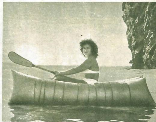
Аэрокатамаран состоит из связанных друг с другом воздушных баллонов — надувных поплавков диаметром 45—47 см и длиной 2—2,5 м. Их можно изготовить из обыкновенной детской клеенки шириной 78—80 см (на тканевой основе). Всего для катамарана потребуется 10—12 м.
