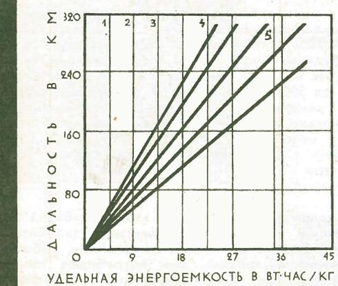
Дальность пробега зависит от удельной энергоемкости и от средней скорости. Правые наклонные линии сверху вниз соответственно для скоростей: 64 км/час, 56 км/час, 48 км/час, 40 км/час, 32 км/час. Цифры сверху обозначают области применения различных видов аккумуляторов: 1 — свинцовые, 2 — никель-кадмийевые, 3 — серебряно-цинковые, 4 — цинко-воздушные, 5 — металло-воздушные.
