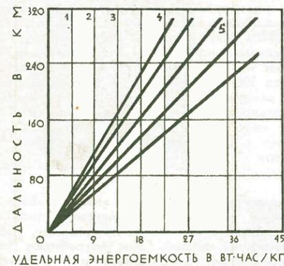
Дальность пробега зависит от удельной энергоёмкости и от средней скорости. Прямые наклонные линии сверху вниз соответственно для скоростей: 64 км/час, 56 км/час, 48 км/час, 40 км/час, 32 км/час. Цифры сверху обозначают области применения различных видов аккумуляторов: 1 — свинцовые, 2 — никель-кадмиевые, 3 — серебряно-цинковые, 4 — цинко-воздушные, 5 — металло-воздушные.
