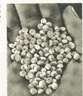
ботала фирма «Эллиот». Суть его такова. Расплавленная сера поступает в центробежные сепараторы, наполненные холодной водой, куда добавляются некоторые связывающие вещества. В результате получают аккуратные, удобные и безопасные для транспортировки гранулы (Англия).
