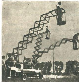
**НОВОЕ ДЛЯ САДОВОДОВ.** На снимке показан гидравлический подъемник с тремя раздвижными корзинами для сбора плодов. Высота корзины регулируется нажатием педали. Установкой «стрел» управляет оператор с земли. Машина снабжена двигателем от легкового автомобиля (ГДР).
