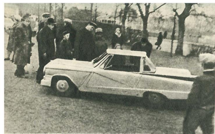
10 Автор машины «Вихрь» Г. Каневцев получил приз «За самый вместительный автомобиль» (86 баллов). Машина выполнена на базе мотоцикла СЗА, открытая, пятиместная, с очень рациональной компоновкой (фото 8).
