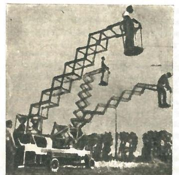
**НОВОЕ ДЛЯ САДОВОДОВ.** На снимке показан гидравлический подъемник с тремя раздвижными корзинами для сбора плодов. Высота корзины регулируется нажатием педали. Установкой «стрел» управляет оператор с земли. Машина снабжена двигателем от легкового автомобиля (ГДР).
