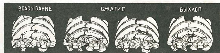
друг с другом. Каким же образом осуществляется сжатие? Дело в том, что винты вращаются с разной скоростью и на «воображаемом» стыке лопастей возникает «бегущее уплотнение».
