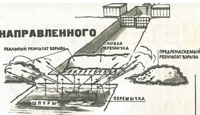
к месту взрыва. И что же? Расчеты были верны — грунт перемычки лежит на берегу, но рядом стоит новая «плотина». Оказывается, взрыв выдавил в глинистом грунте котлована новую перемычку — в виде складки, по размерам равную первой. Ее уже пришлось убрать по-другому — экскаваторами.
